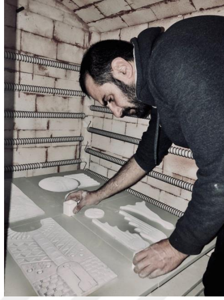
Resim 5.61. Fırın doldurma işlemi
