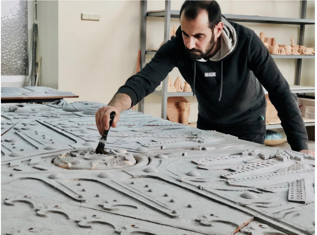
Resim 5.59. Siyah sır ile eskitme işlemi
