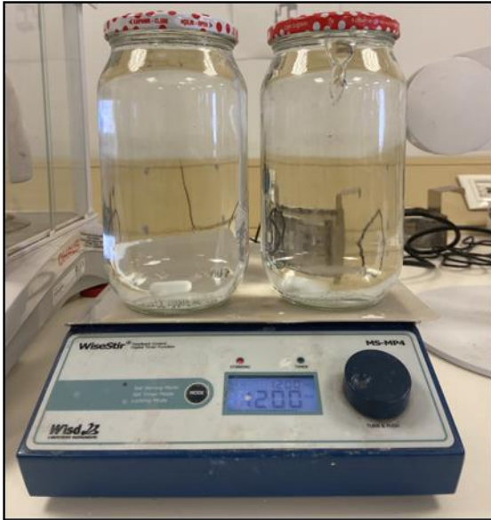
Resim 3.7. Manyetik karıştırıcı ile demineralizasyon solüsyonunun hazırlanması
