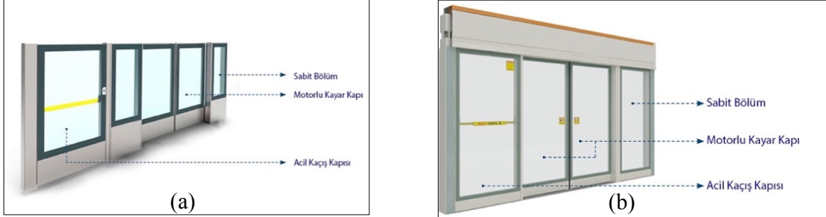
Şekil 3.16. (a) Yarı yükseklikte peron kapısı, (b) Tam yükseklikte peron kapısı [68]
