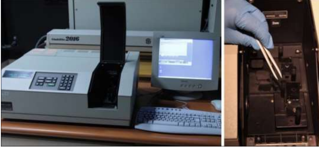
Resim 4.6. Morötesi-görünür bölge spektrometresi (Perkin Elmer Lambda 2S)
