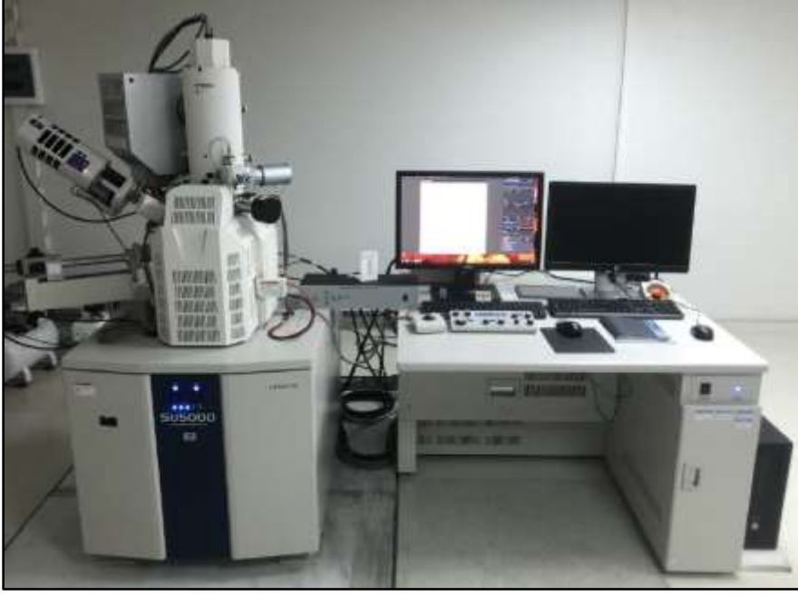
Resim 4.7. Taramalı elektron mikroskobu sistemi (Hitachi SU500)
