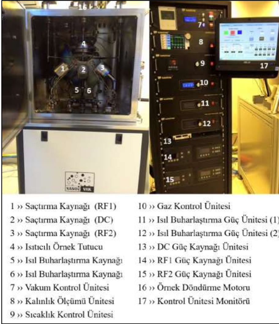
Resim 4.1. Eş Püskürtme Sistemi (Nanovak NVTs-500)
