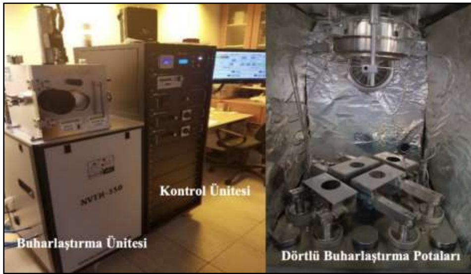
Resim 4.2. Termal Buharlaştırma Sistemi (Nanovak NVTH-350)
