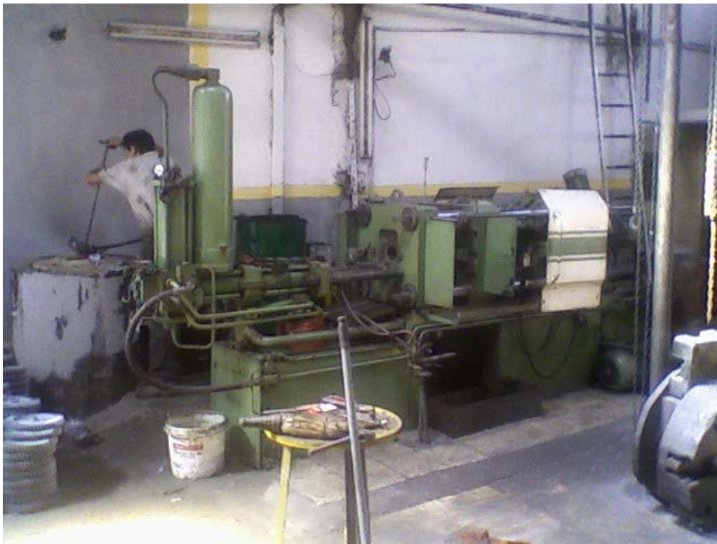
Resim 5.4. Yatay soğuk kamaralı 160 tonluk metal enjeksiyon makinesi
