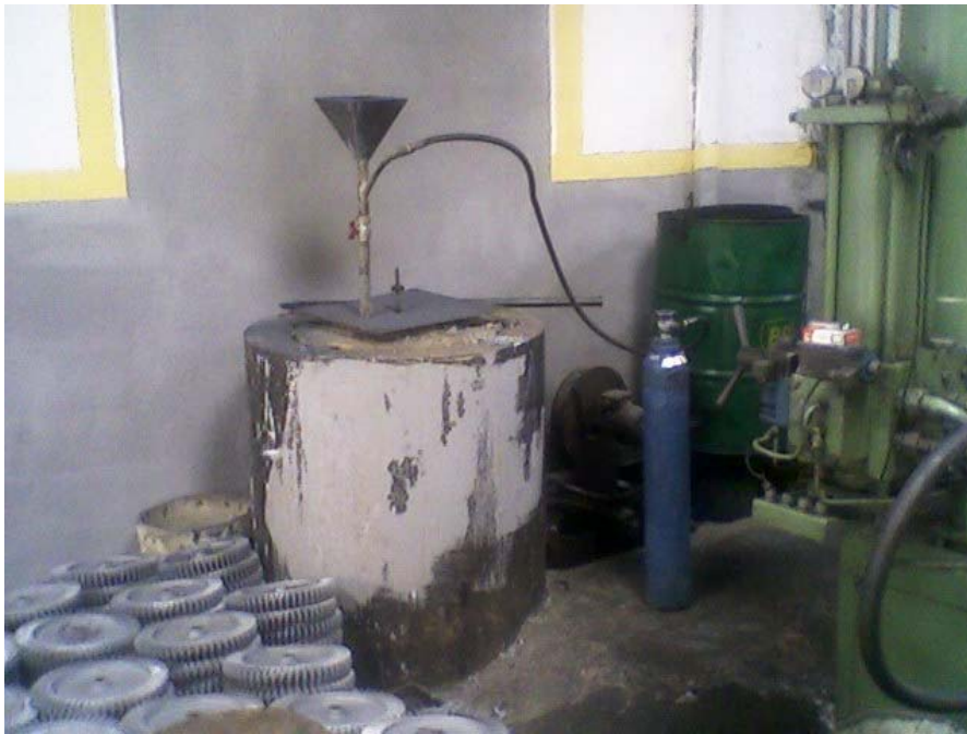
Resim 5.1. Vorteks düzeneği ve alüminyum ergitme ocağı
