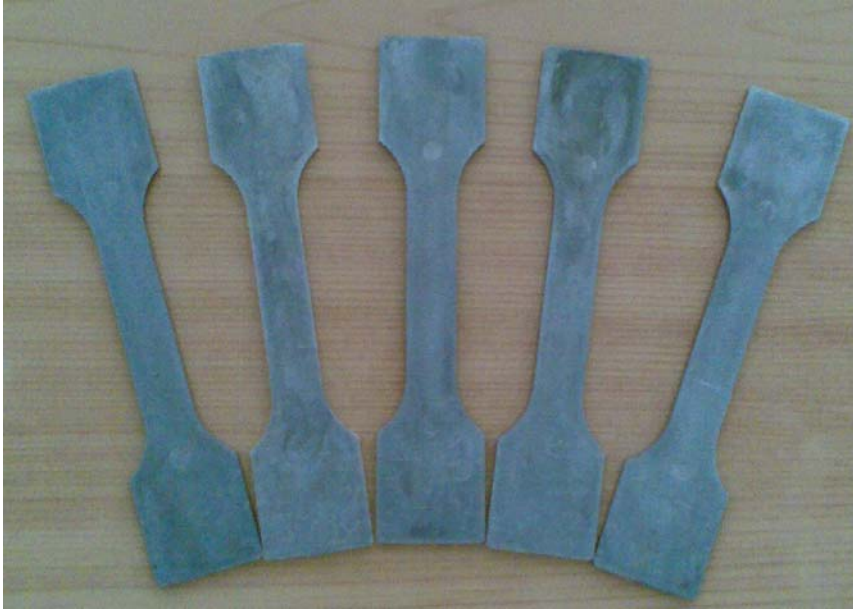
Resim 5.8. Çekme deneyi numuneleri
