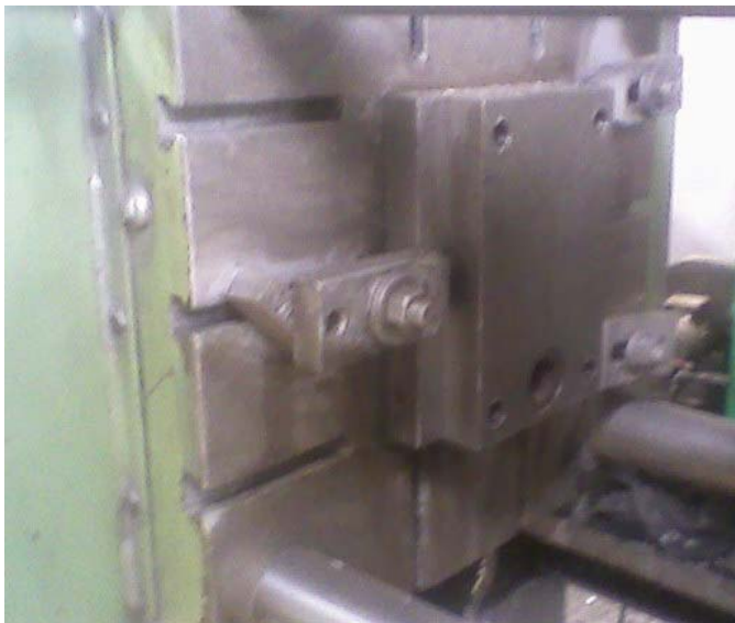
Resim 5.6. Metal enjeksiyon kalıbı sabit taraf
