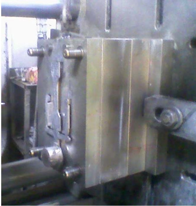
Resim 5.5. Metal enjeksiyon kalıbı hareketli taraf
