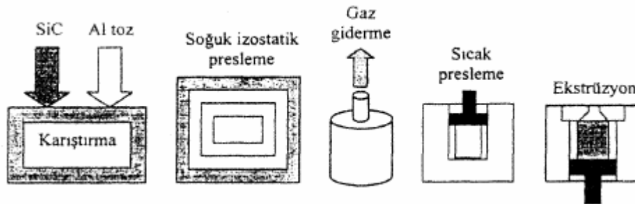
Şekil 4.15. Toz metalurjisi yöntemi ile kompozit üretim aşamaları [4]
