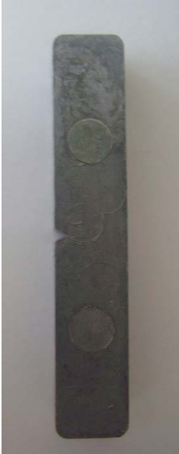
Resim 5.9. V çentikli numune
