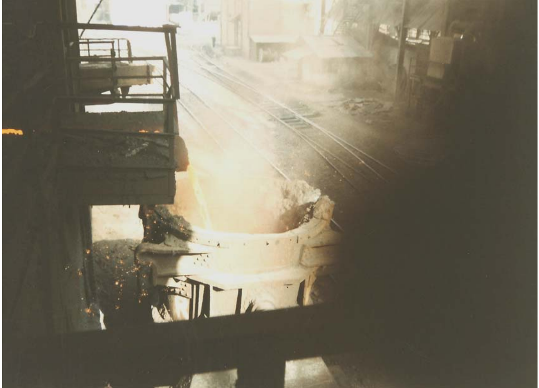
Resim 4.2. Cürufun potalarda atmosfer sıcaklıęında soęuması
