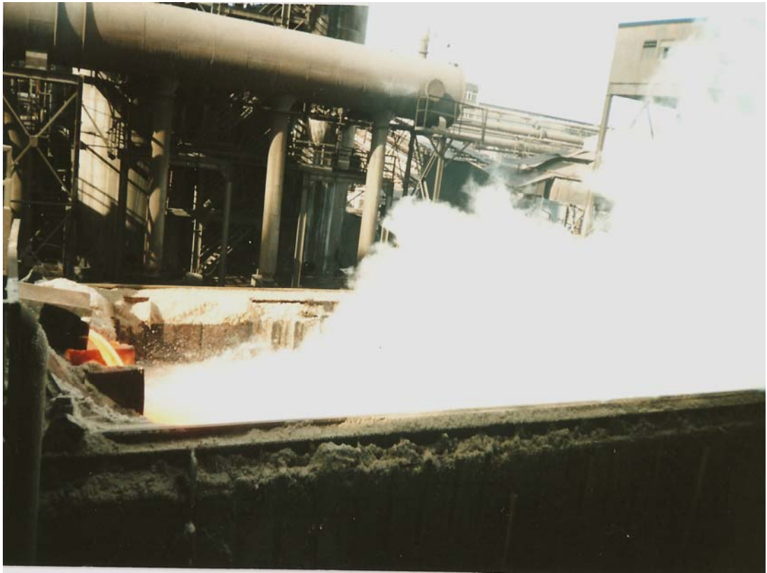
Resim 4.3. Yüksek fırın cüruflarının tazyikli su verilerek soğutulması ve granüle hale gelmesi
