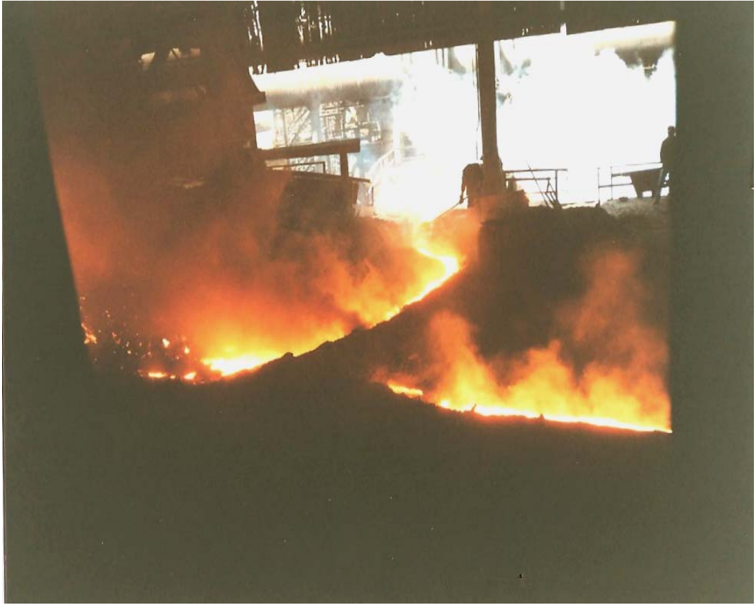
Resim 4.1. Cüruf ile pik demirin ayrılması
