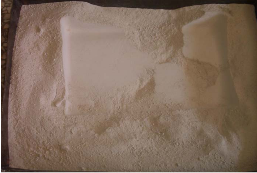
Resim 7.2. Kullanılan diatomitin değirmenden geçirilerek öğütülmüş durumu
