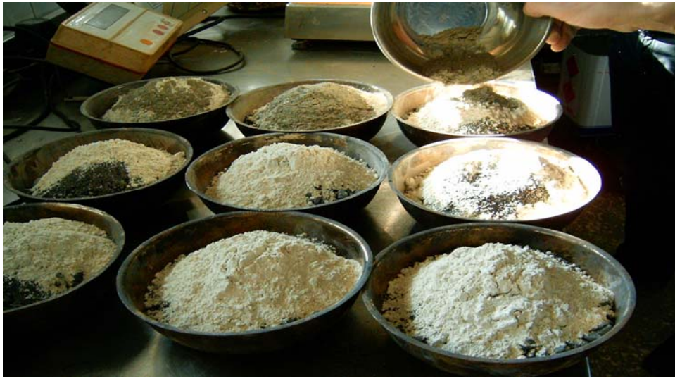
Resim 8.2. Marshall briketlerinin tartımlarının alınması
