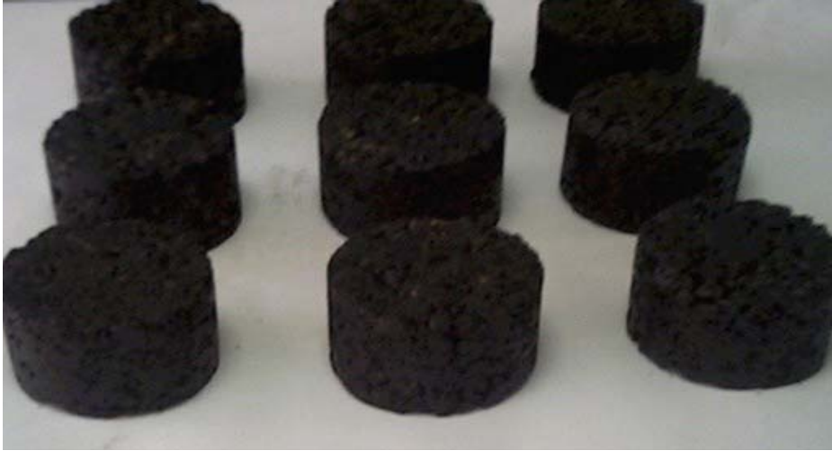
Resim 8.7. Marshall briketlerinin kalıplardan çıkartılmış durumu
