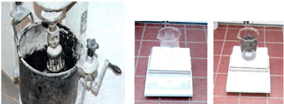
Resim 8.8. TMA karışımının hazırlanması ve cam beherin boş ve karışım dolu tartımı
