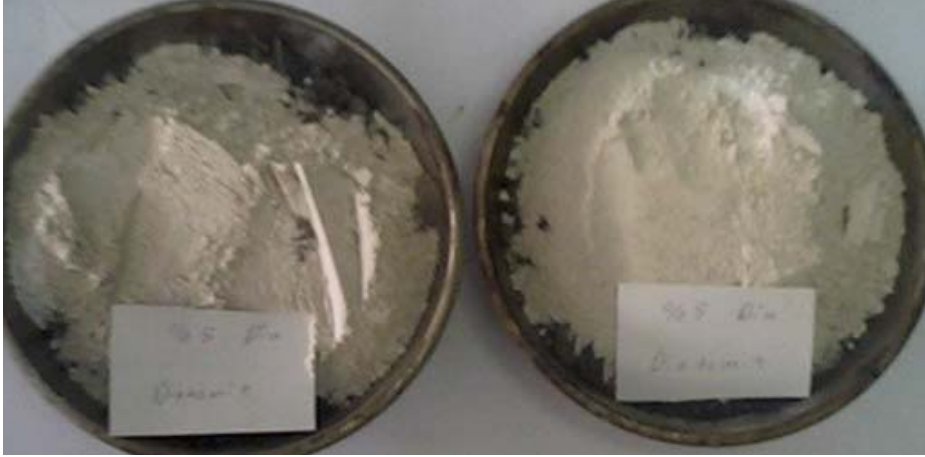
Resim 8.5. Diatomit tartımları örneği (%5 diatomitli)
