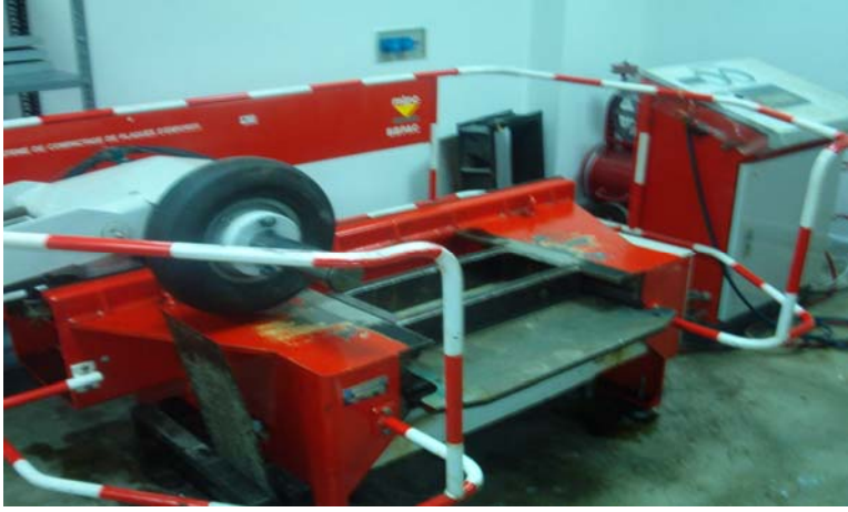
Resim 8.13. TİO deneyi numuneleri sıkıştırma aleti
