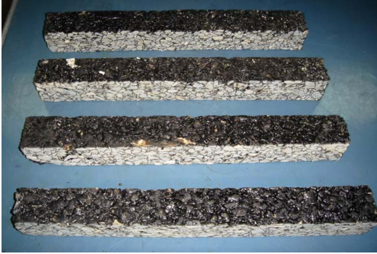
Resim 8.17. Diatomitli yorulma (fatigue) deney numuneleri
