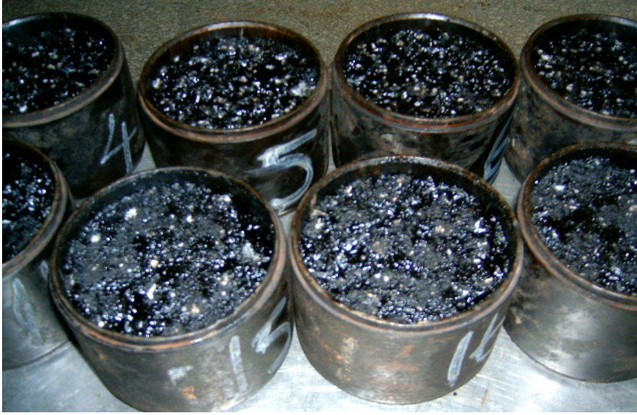
Resim 8.6. Marshall briketleri kalıplar içindeki durumu
