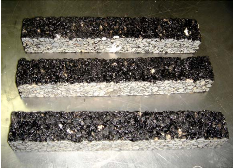
Resim 8.18. Fiberli yorulma (fatigue) deney numuneleri
