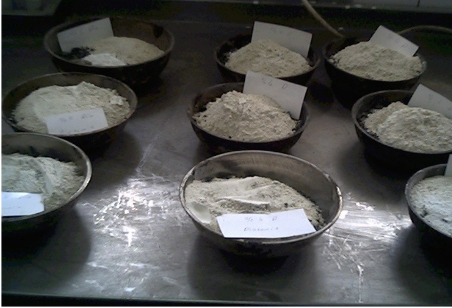
Resim 8.4. Diatomit tartımları örneği (%4 diatomitli)
