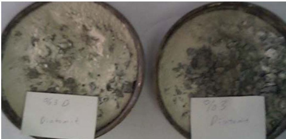
Resim 8.3. Diatomit tartımları örneği (%3 diatomitli)
