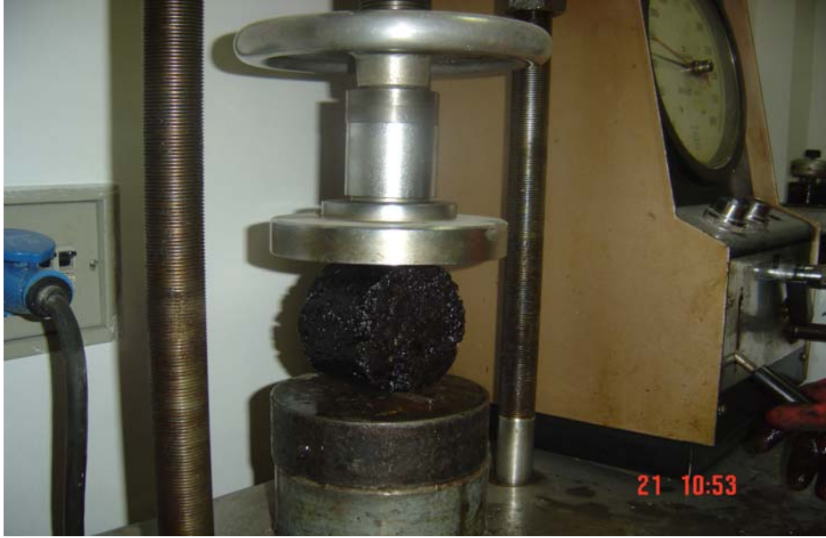
Resim 8.12. İÇM deneyinde kullanılan yükleme ünitesi
