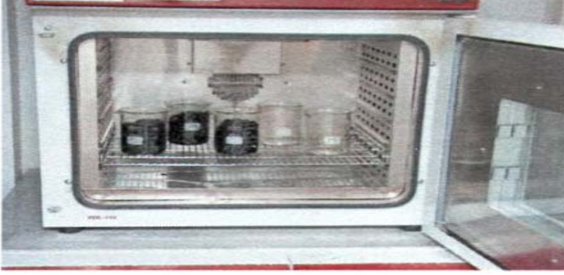
Resim 8.9. Hazırlanan karışımın 1 saat 170°C etüvde bekleme durumu
