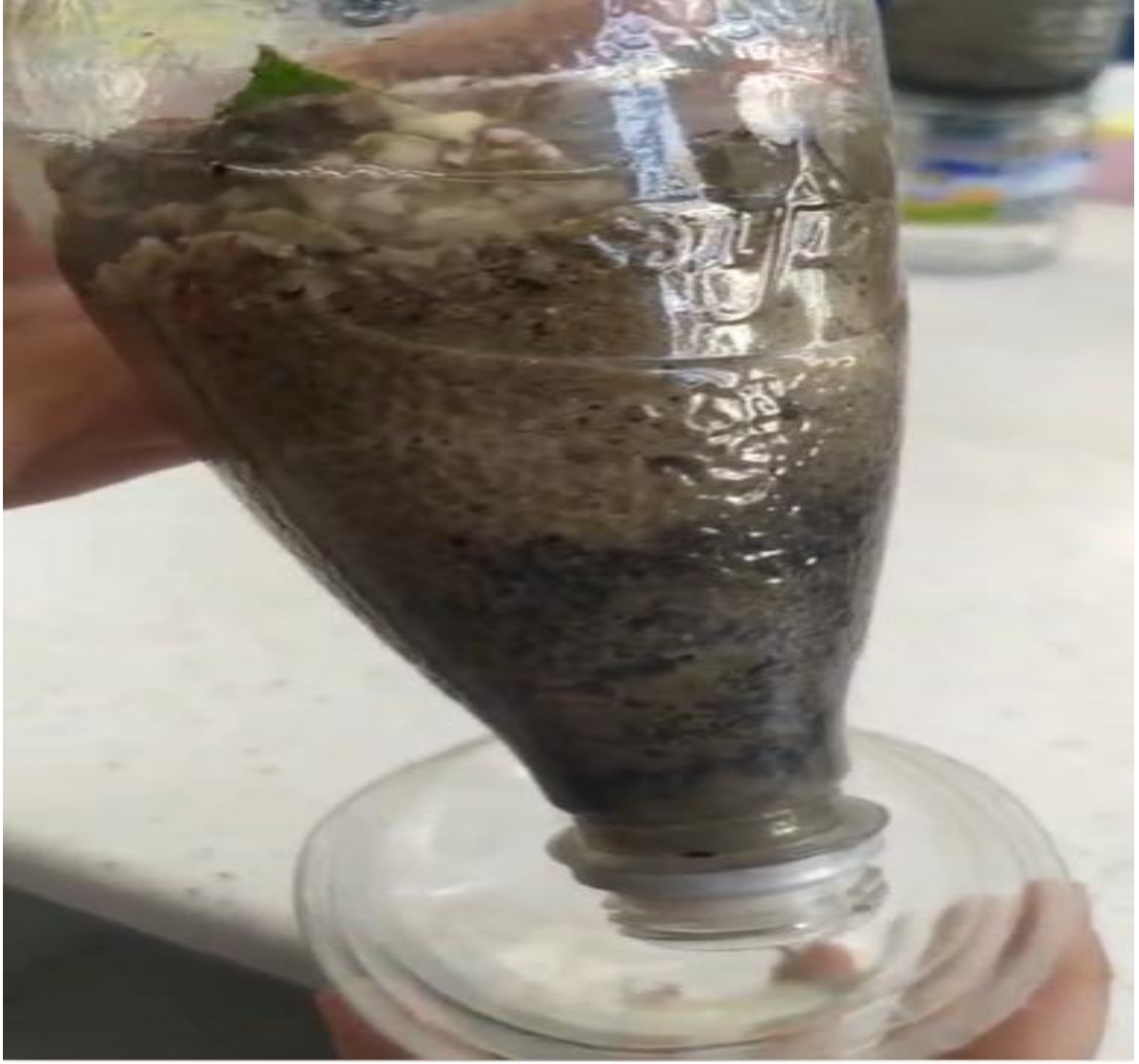
Şekil 2. Öğrenci tarafından geliştirilen basit su arıtma prototipi - 1
