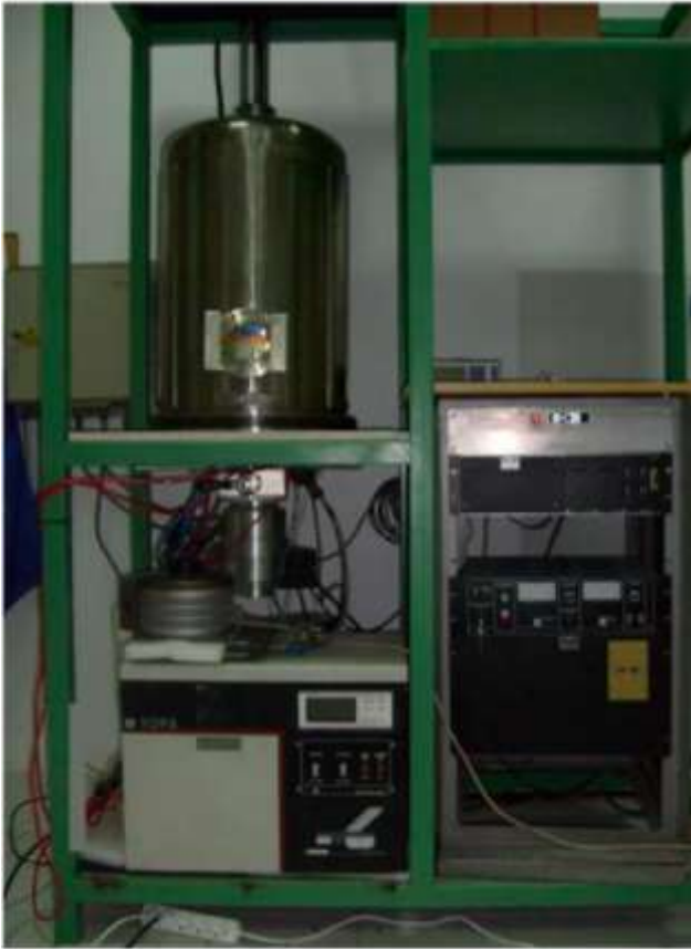
Şekil 3.5. Termal buharlaştırma ve elektron demeti ile buhar biriktirme yöntemlerinin her ikisini aynı anda içeren fiziksel buharlaştırma (PVD)sistemi
