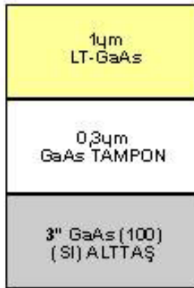
Şekil 4.6. GaAs için MBE'de büyüme periyodu
