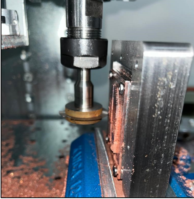
Şekil 4.15. Kanatçık açma prosesi
