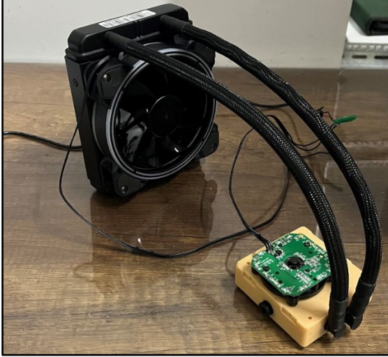
Şekil 4.20. Prototip sıvı soğutma sistemi
