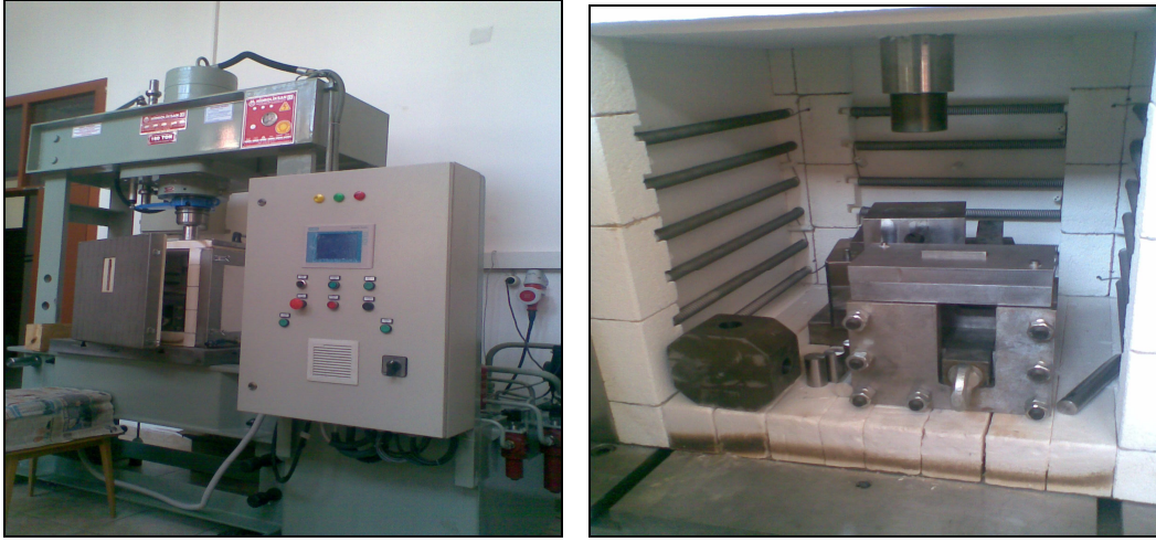
Resim 4.1. Presleme işlemi yapılan tek etkili presleme cihazının görüntüsü
