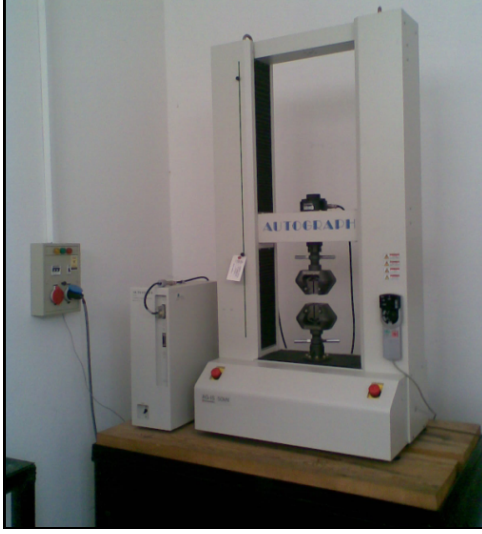
Resim 4.6. SHIMADZU marka 50 kN kapasiteli çekme test cihazı
