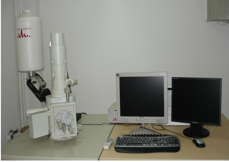
Resim 4.5. JOEL JSM-6060LV model taramalı elektron mikroskobu ve EDS bağlantısı
