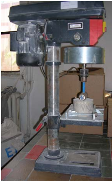
Resim 3.3. Aşınma dayanımı deney cihazı ve aşındırma aparatı
