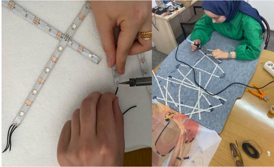
Şekil 16. İletken tellerin LED ışıklara lehimlenmesi
