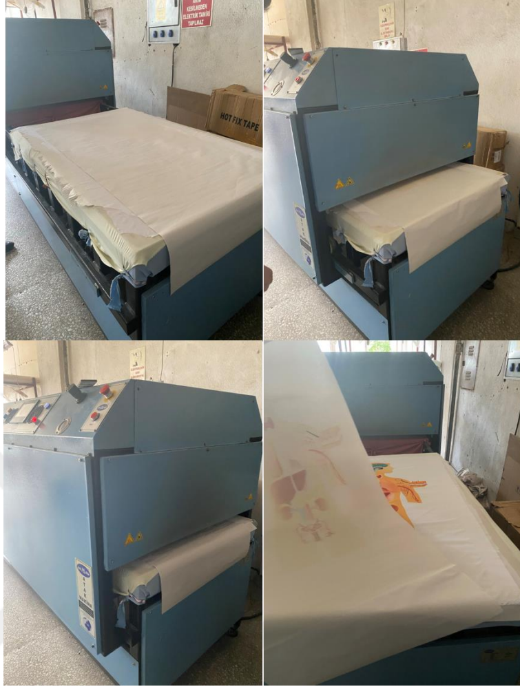
Şekil 8. Pres makinesi ile görsellerin tela kumaşlara basılması
