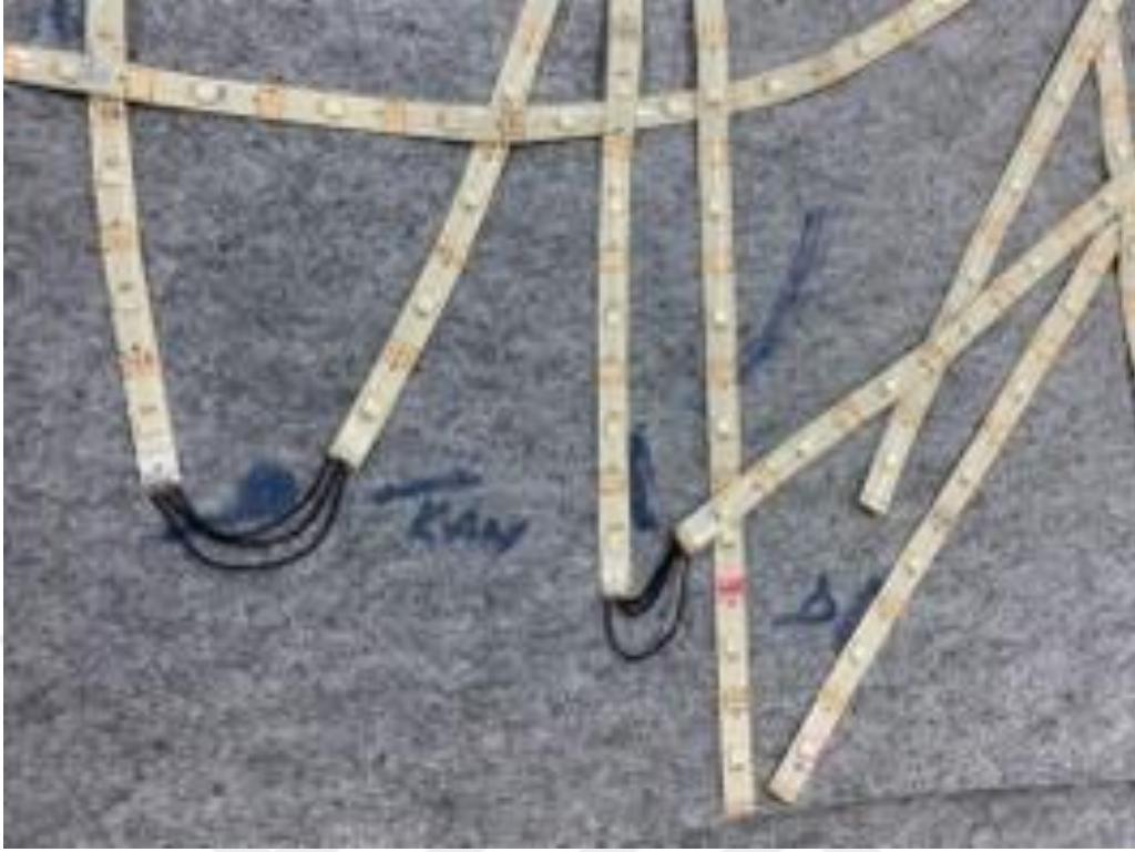
Şekil 17. İletken teller ile oluşturulan kıvrım noktaları
