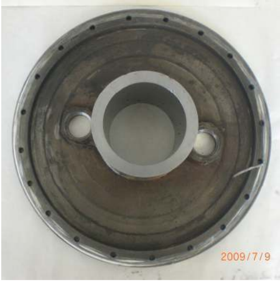
Resim 5.3. Güç silindiri ve yer değıştirme silindirinin soğuk hacmi
