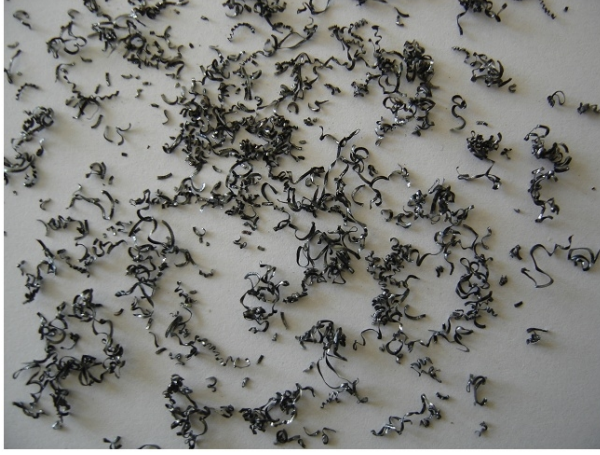
Resim 6.9. BHO 10 numunelerde oluşan talaş
