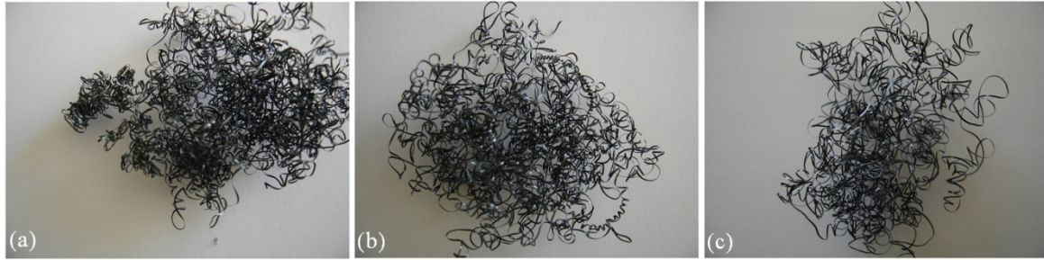
Resim 6.8. Beynit hacim oranına bağlı talaş oluşumu a) BHO 30 b) BHO 40 c) BHO 50
