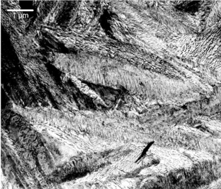
Resim 3.3. AISI 52100 çeliğinde alt beynit (Vetters ve diğerleri, 2006)
