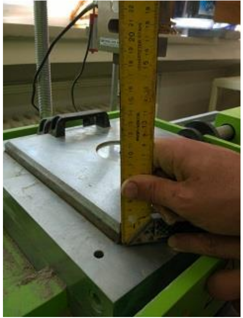
Resim 6.2. Büyük ölçekli kesme deneyi için ölçülerin alınması ve deney numunesinin hazırlanması
