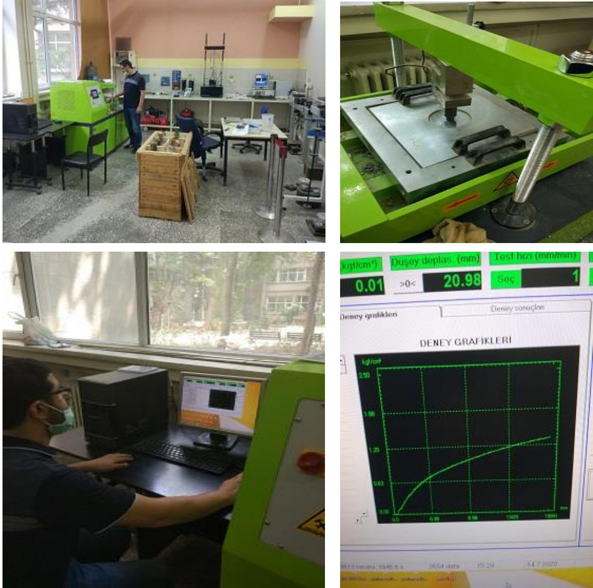
Resim 6.3. Büyük ölçekli kesme deneyinin yapılması
