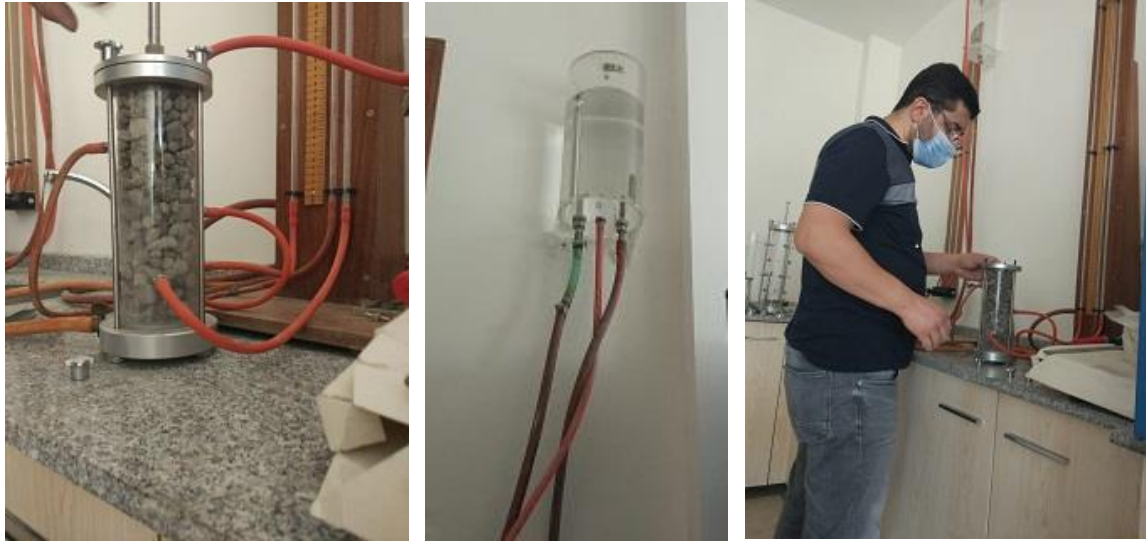
Resim 6.1. Sabit düzeyli geçirimsizlik deneyinin yapılışı
