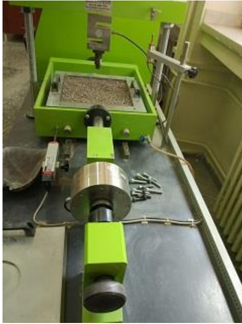
Resim 6.2. Büyük ölçekli kesme deneyi için ölçülerin alınması ve deney numunesinin hazırlanması
