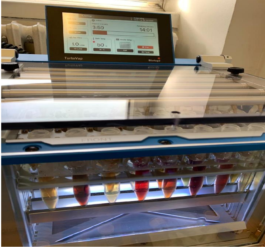
Resim 3.4. Azot jeneratörlü Turbovap cihazına yüklenmiş numuneler
