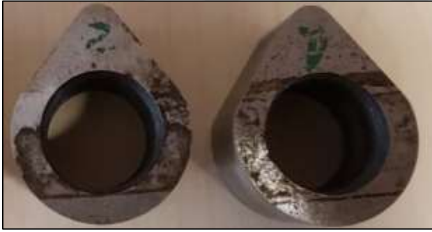
Resim 4.3. İmal edilen kam profilleri
