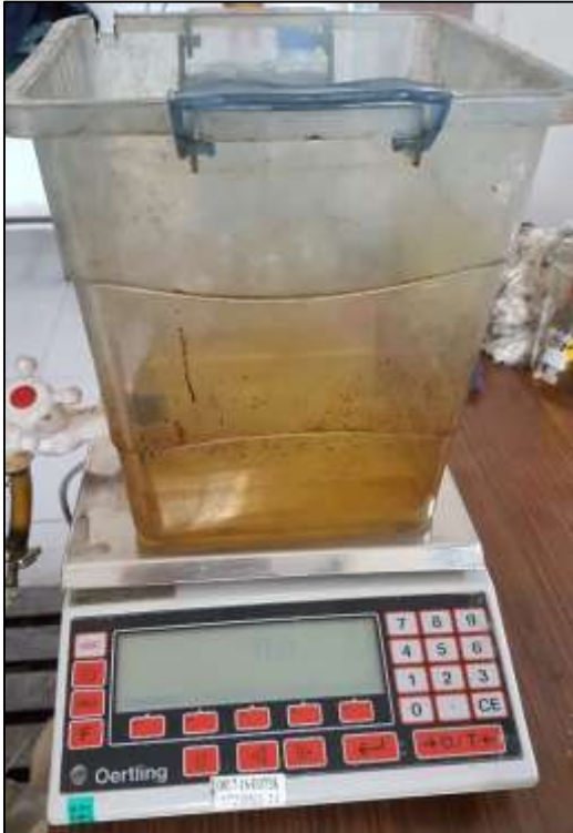
Resim 4.11. Hassas terazi ve yakıt kabı
