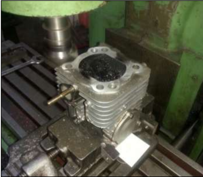
Resim 4.6. Silindir kapağından talaş kaldırılması
