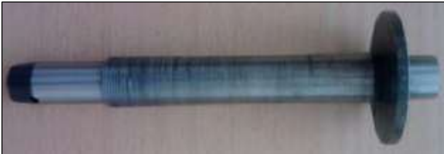
Resim 4.4. Supap zamanlaması ayarlanabilir kam mili [55]
