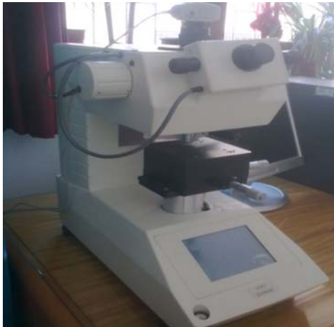
Resim 6.11. Sertlik ölçümlerinin yapıldığı Shimadzu HVM2 sertlik cihazı
