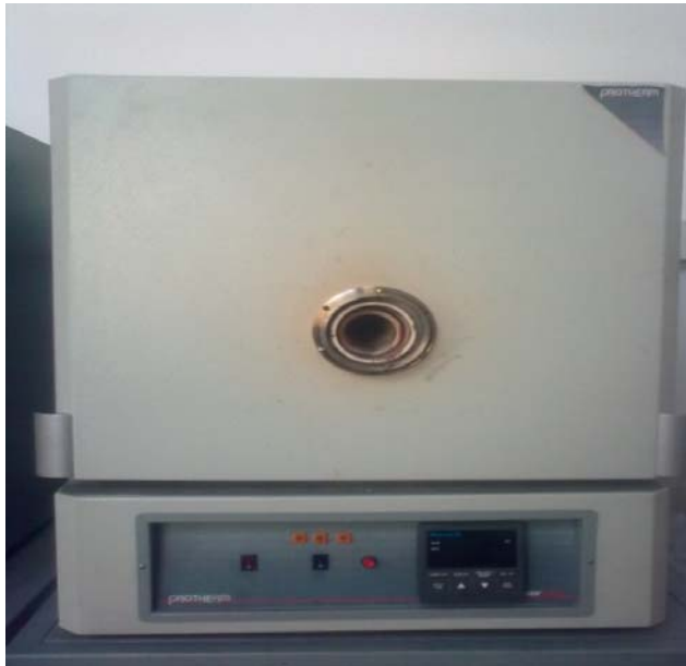
Resim 6.6. Sinterleme ve yaşlandırma ısı işlemlerinin yapıldığı fırın
