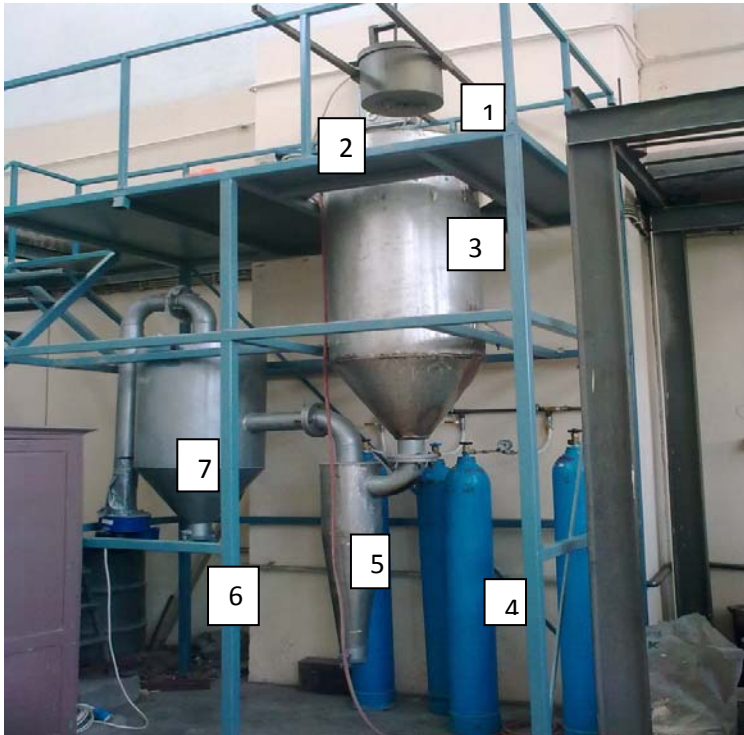
Resim 6.1. Düşey gaz atomizasyon ünitesi (1.Ergitme ünitesi, 2. Sıcaklık ünitesi, 3.Atomizasyon kulesi, 4.Basınçlı gaz ünitesi, 5. Toz toplama ünitesi, 6. Fan, 7. Siklon)
