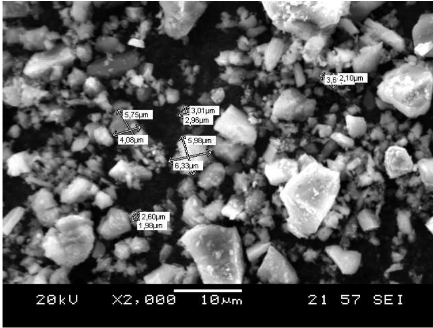
Resim 7.1. Takviye tozu olarak kullanılan Al 4 C 3 ' ün SEM görüntüsü
