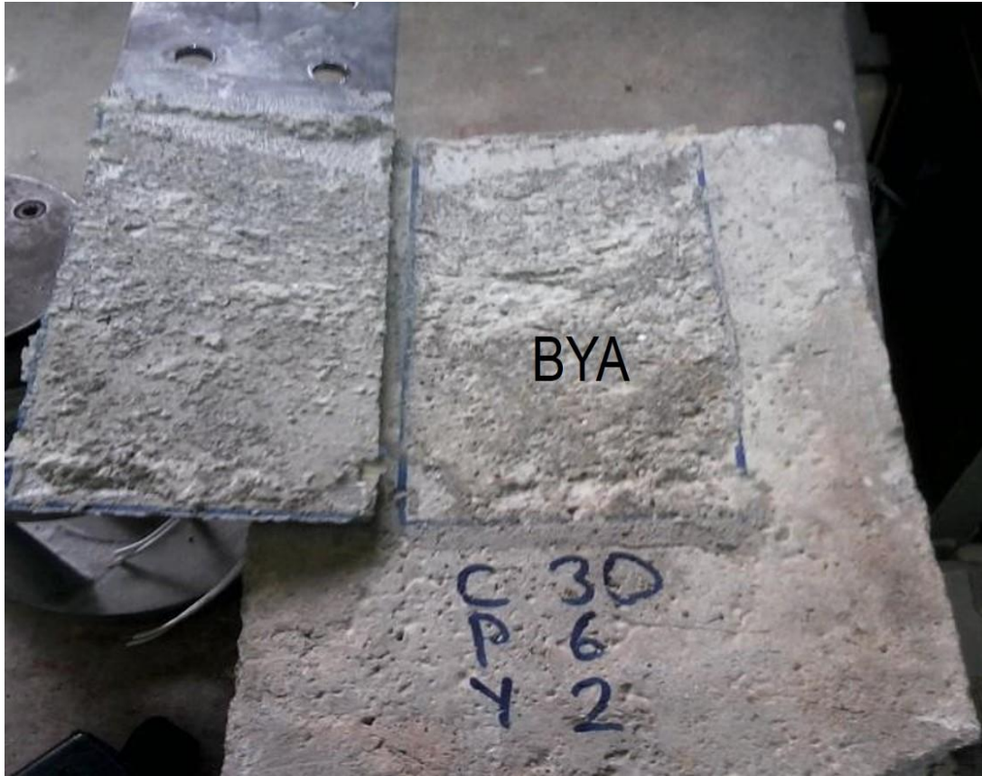
Resim 4.17. C30P6Y2 numunesinde oluşan ayrılma durumu
