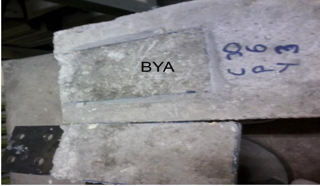
Resim 4.18. C30P6Y3 numunesinde oluşan ayrılma durumu
