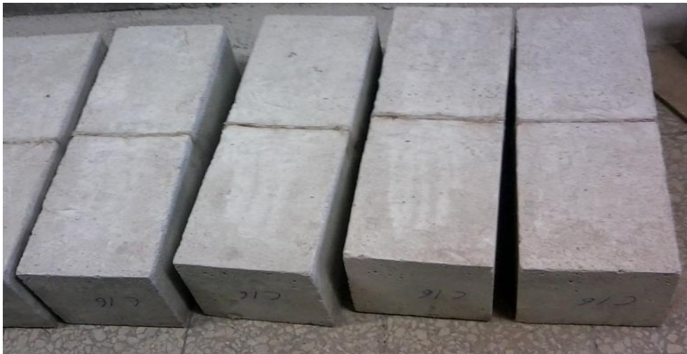
Resim 3.2. Kalıplarından çıkarılan beton numuneler
