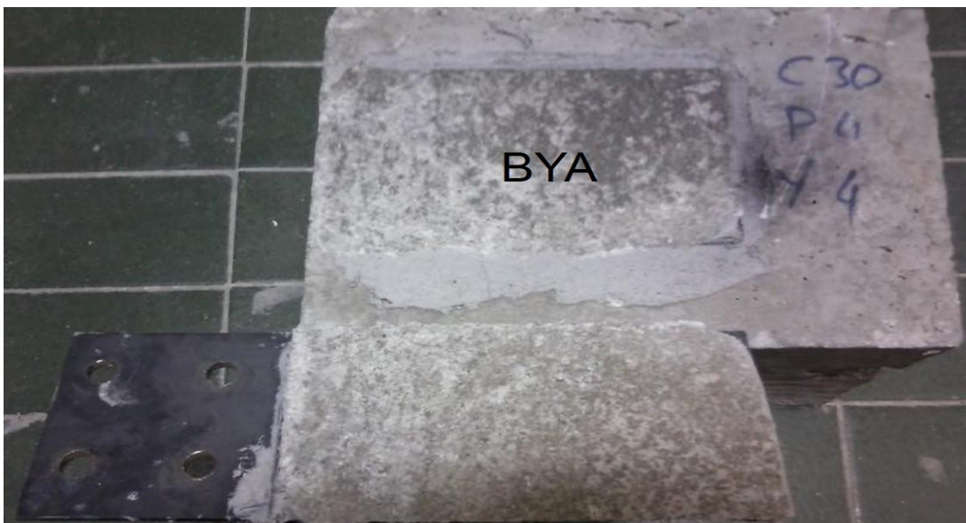
Resim 4.16. C30P4Y4 numunesinde oluşan ayrılma durumu
