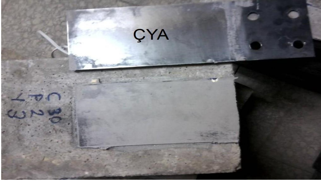
Resim 4.12. C30P2Y3 numunesinde oluşan ayrılma durumu
