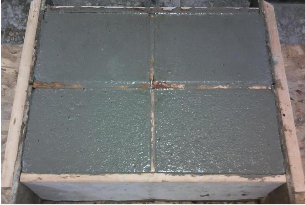
Resim 3.1. Betonun ikili kalıplara yerleştirilmiş hali
