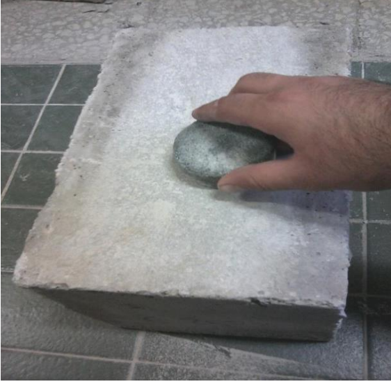
Resim 3.4. Beton numune yüzeyinin zımparalanması
