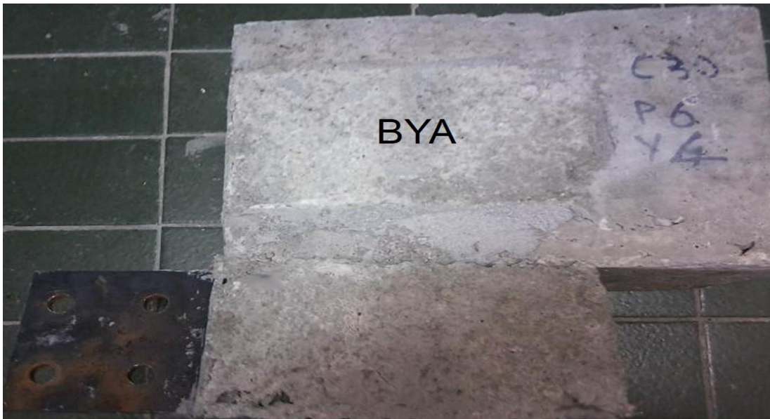
Resim 4.19. C30P6Y4 numunesinde oluşan ayrılma durumu
