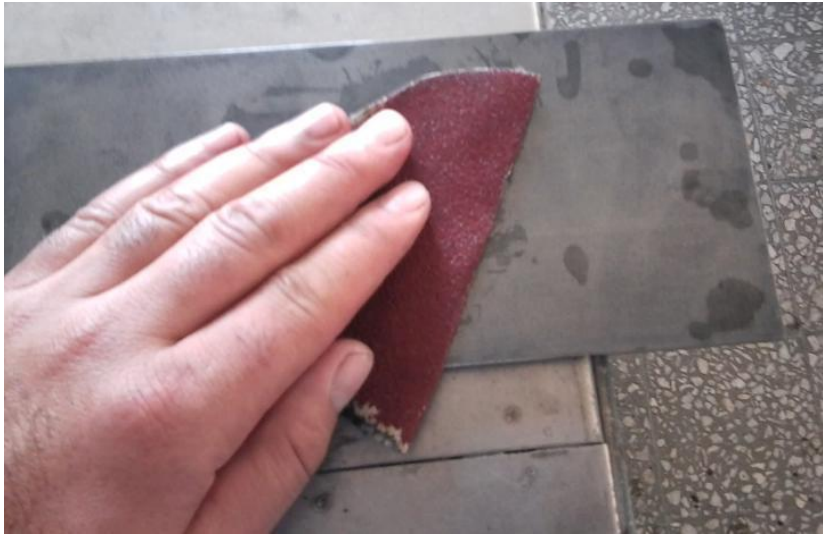
Resim 3.5. Çelik plaka yüzeyinin zımpara ile temizlenmesi
