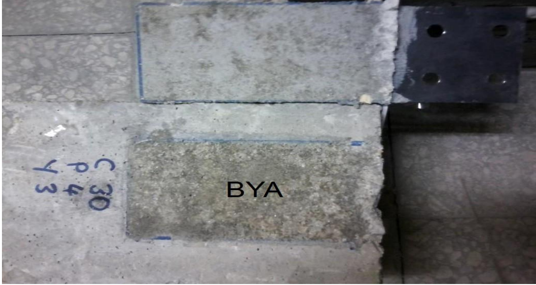
Resim 4.15. C30P4Y3 numunesinde oluşan ayrılma durumu
