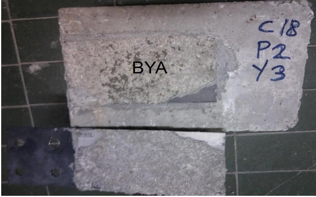
Resim 4.3. C18P2Y3 numunesinde oluşan ayrılma durumu
