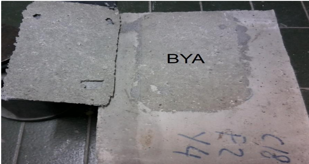
Resim 4.4. C18P2Y4 numunesinde oluşan ayrılma durumu
