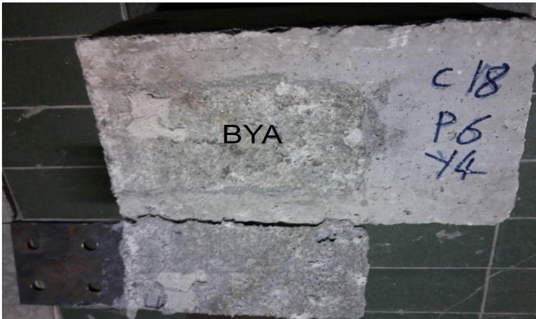
Resim 4.10. C18P6Y4 numunesinde oluşan ayrılma durumu
