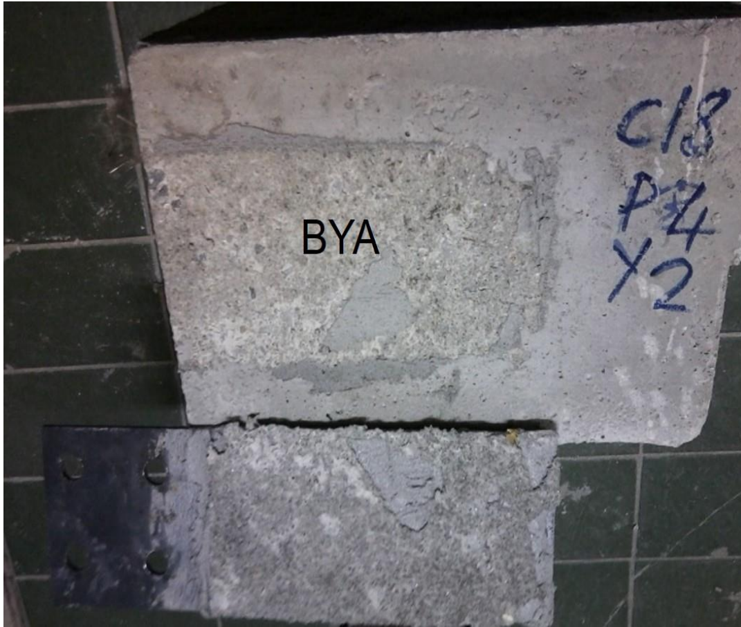
Resim 4.5. C18P4Y2 numunesinde oluşan ayrılma durumu
