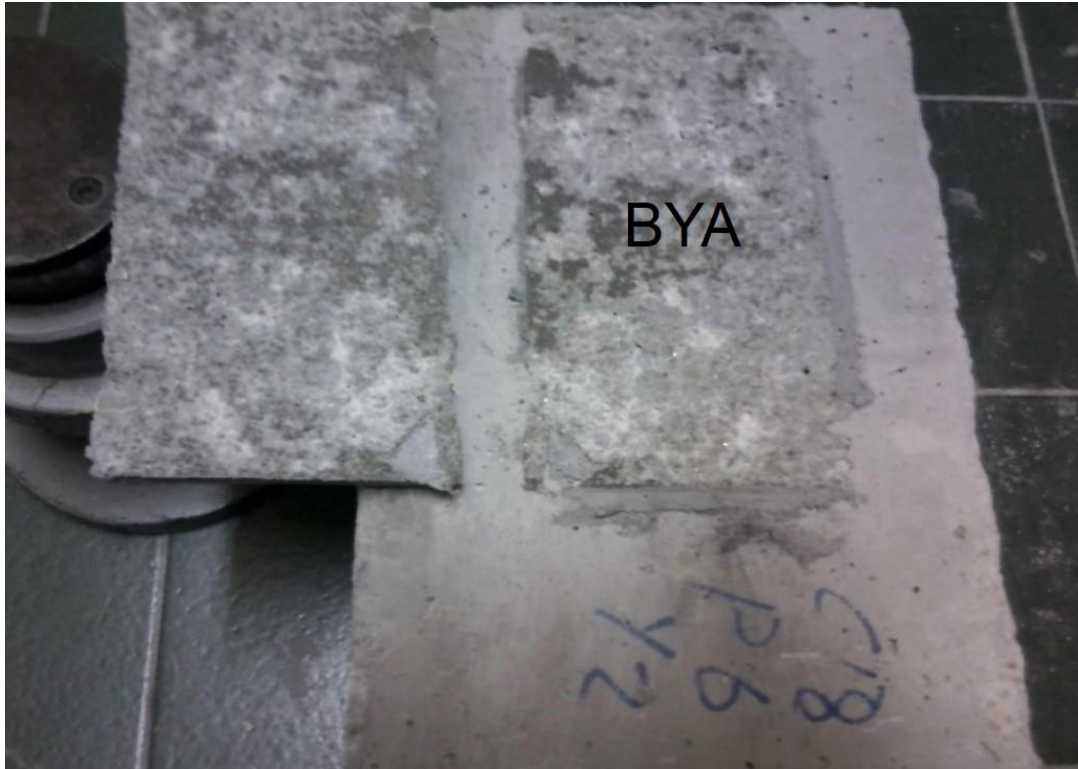
Resim 4.8. C18P6Y2 numunesinde oluşan ayrılma durumu
