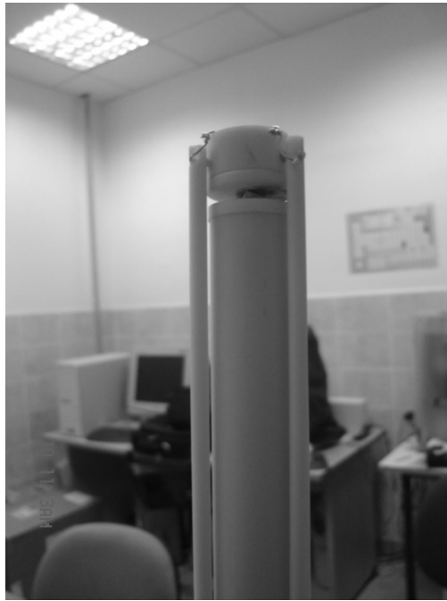
Resim 3.5. Yüksek sıcaklık numune tutucusu
