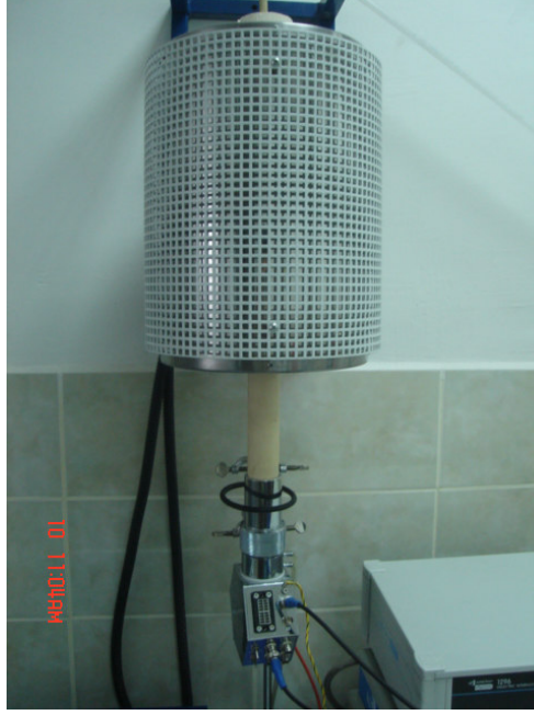
Resim 3.6. Numune tutucusunun ısıtıldığı fırın
