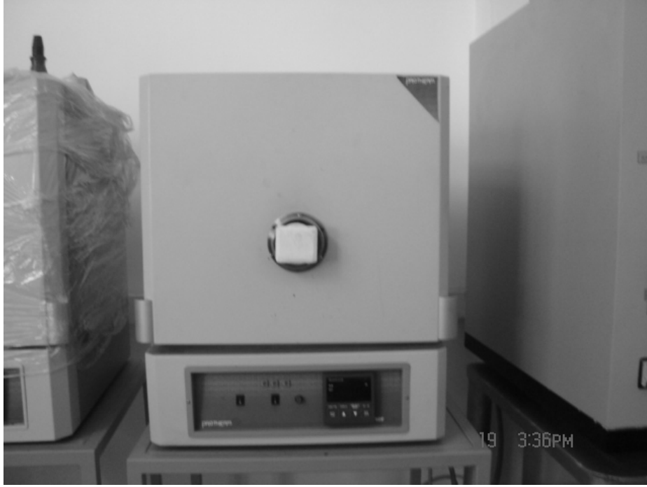
Resim 3.2.Sinterleme işlerinde kullanılan kutu tipi fırın
