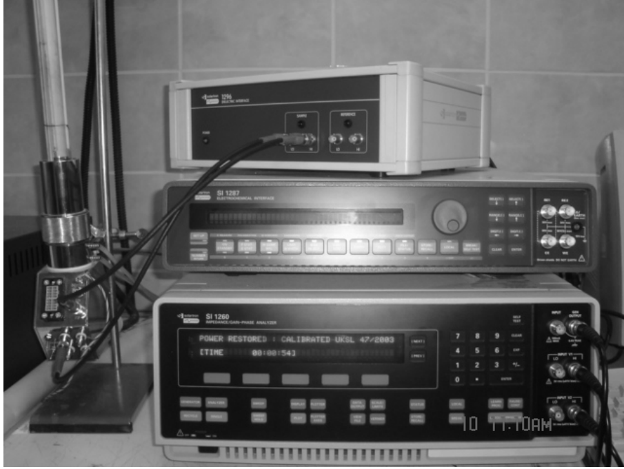
Resim 3.4. Solartron 1260 ve 1296 marka yüksek frekans empedans analiz cihazı
