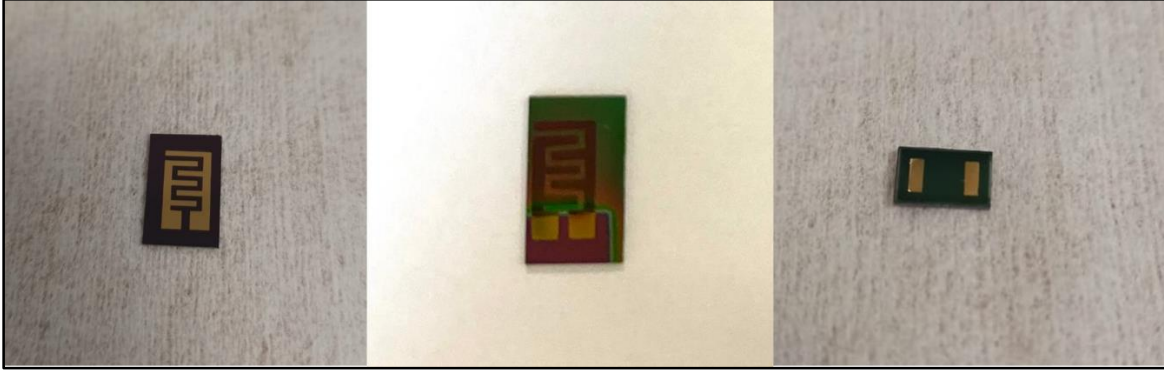
Resim 7.1. İnterdijital elektrotlu tasarlanan VO_x tabanlı kızılötesi dedektörler
