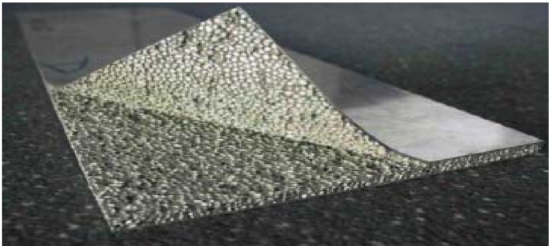
Resim 4.4. Karmann, (Almanya) tarafından üretilmiş alüminyum köpük sandviç(AFS) [3, 12, 13]
