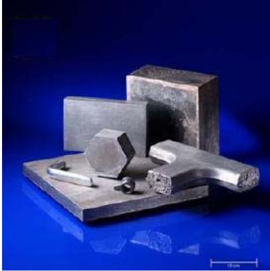
Resim 3.10. IFAM tarafından T/M yöntemi ile üretilmiş Al köpük parçalar [31]
