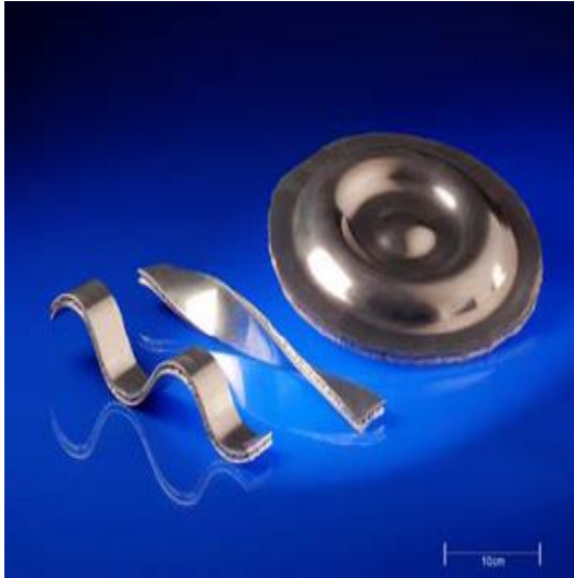
Resim 3.11. Bükülmüş Al sandviç köpükler [31]
