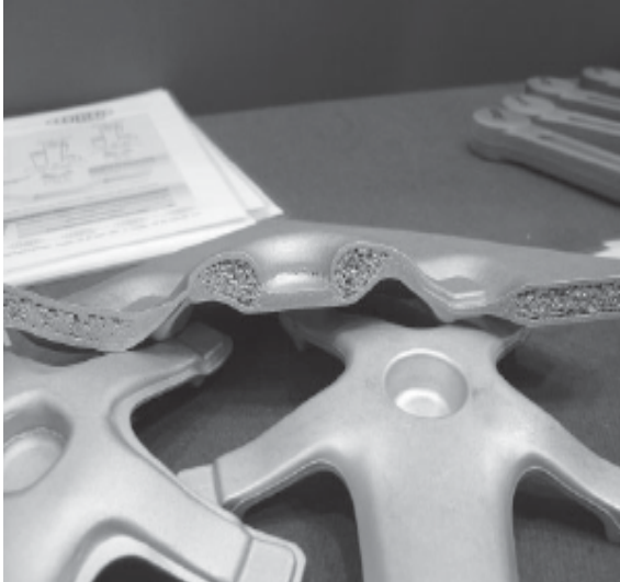
Resim 4.2. Karmaşık şekilli alüminyum sandviç köpük kesiti [37]
