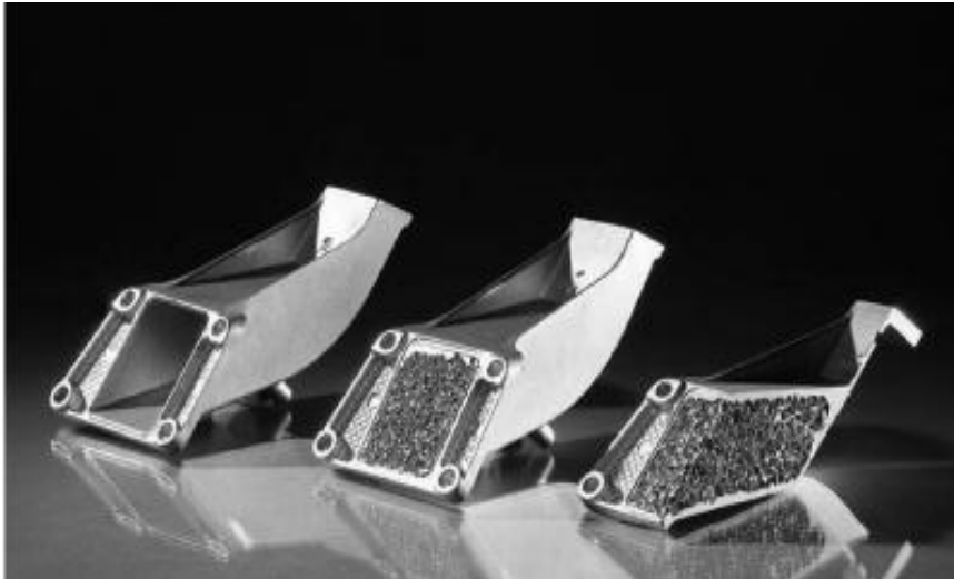
Resim 4.9. LKR Ranshofen(Avusturya) tarafından üretilmiş BMW motor montaj desteği. Soldan sağa: boş döküm, köpük çekirdeği ve döküm kovani içeren bütün kompozit, kompozit bölümün kesiti [12]
