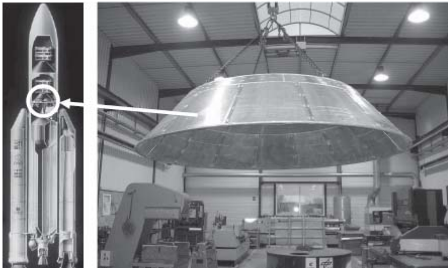
Resim 4.12. Alüminyum köpük sandviç (AFS) ile yapılmış prototip yapı [37]
