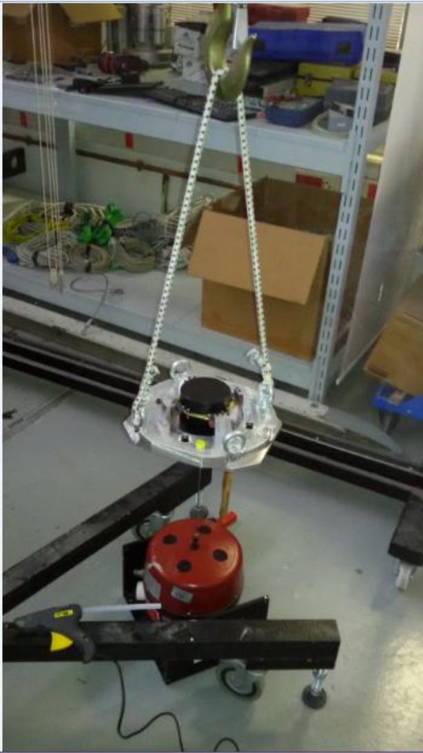
Resim 6.1. Serbest-Serbest sınır koşulu ile sinüs tarama testi düzeneği
