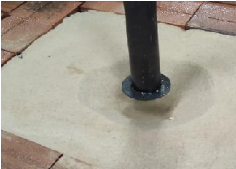
Şekil 3.10. Deneyler sonucunda elde edilen tipik bir oyulma çukuru geometrisi
