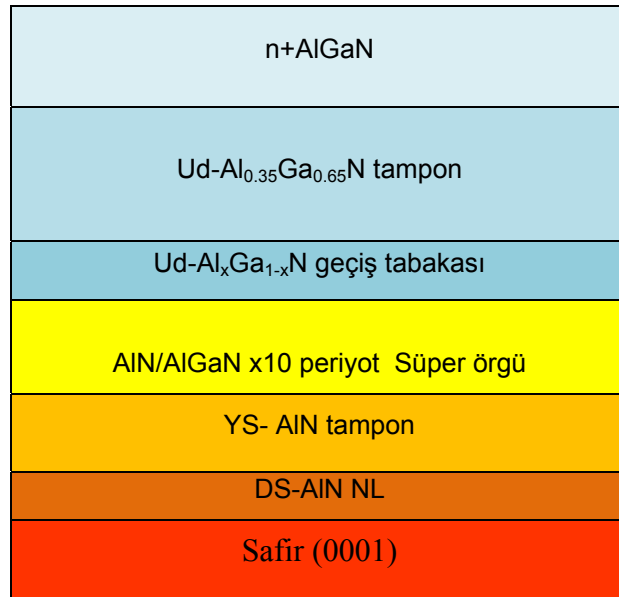
Şekil 4.10. AlGa N :Si ile tampon tabakalarının şematik gösterimi
