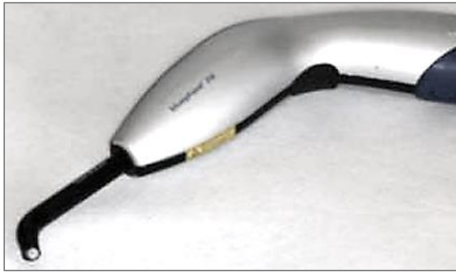
Resim 3.3. 3. Jenerasyon LED ışık cihazı Bluephase 20i
