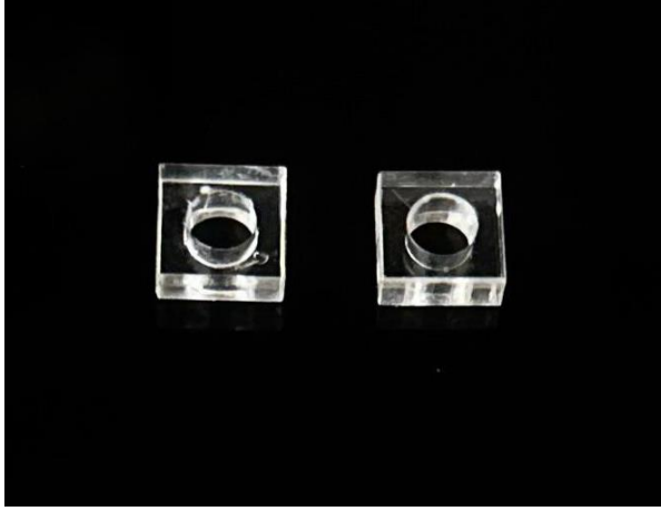
Resim 3.5. Örneklerin hazırlanmasında kullanılan 5x4 mm pleksiglas kalıplar
