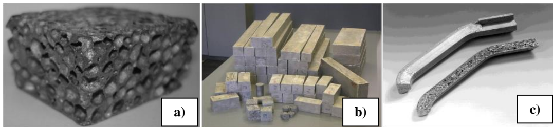
Resim 2.4. TM yöntemi ile üretilmiş köpük parçalar [Baumgärtner ve ark., 2000; Peroni ve ark., 2007]. a) Homojen gözenekli yapı, b) Mekanik testler için üretilmiş Al köpük bloklar, c) Elektrikli bir trenin korna çalma aparatı
