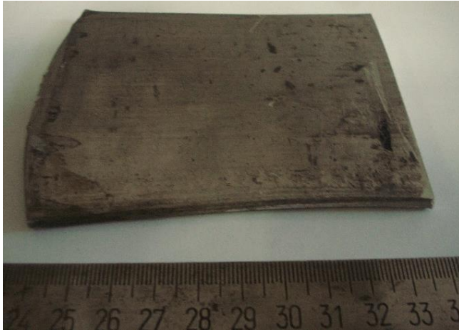
Resim 8.6. Haddeme işlemleri sonrası levha haline getirilen köpürebilir malzeme
