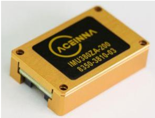
Şekil 2.6. IMU (Atalet Ölçüm Birimi) (Teschler)
