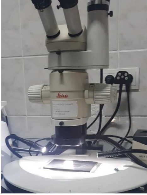
Resim 3.24. Test örnekleri bağlanma dayanımı testi sonrasında kırık tipinin belirlenmesi için ışık mikroskobu altında incelenmesi
