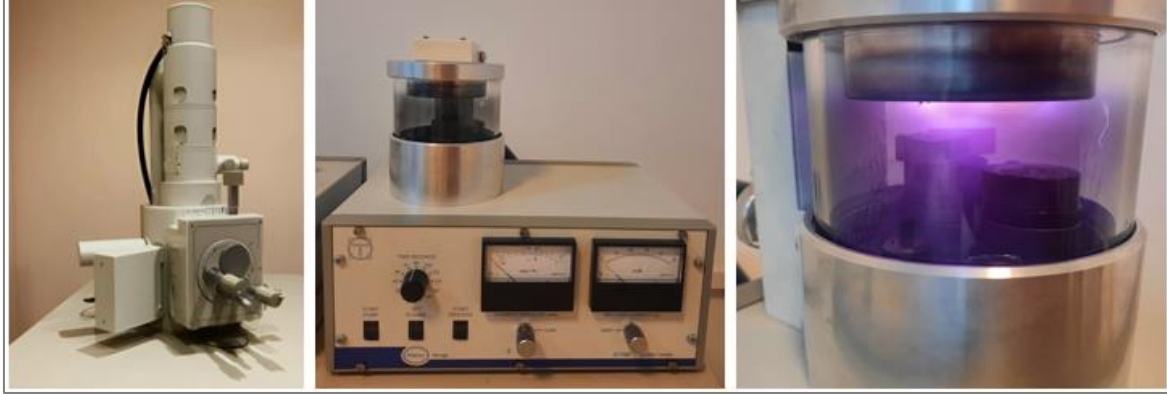
Resim 3.12. Taramalı elektron mikroskobu, Altın-paladyum kaplama ünitesi ve CAD/CAM PMMA kaide materyali test örneği yüzeyinin altın ile kaplanması
