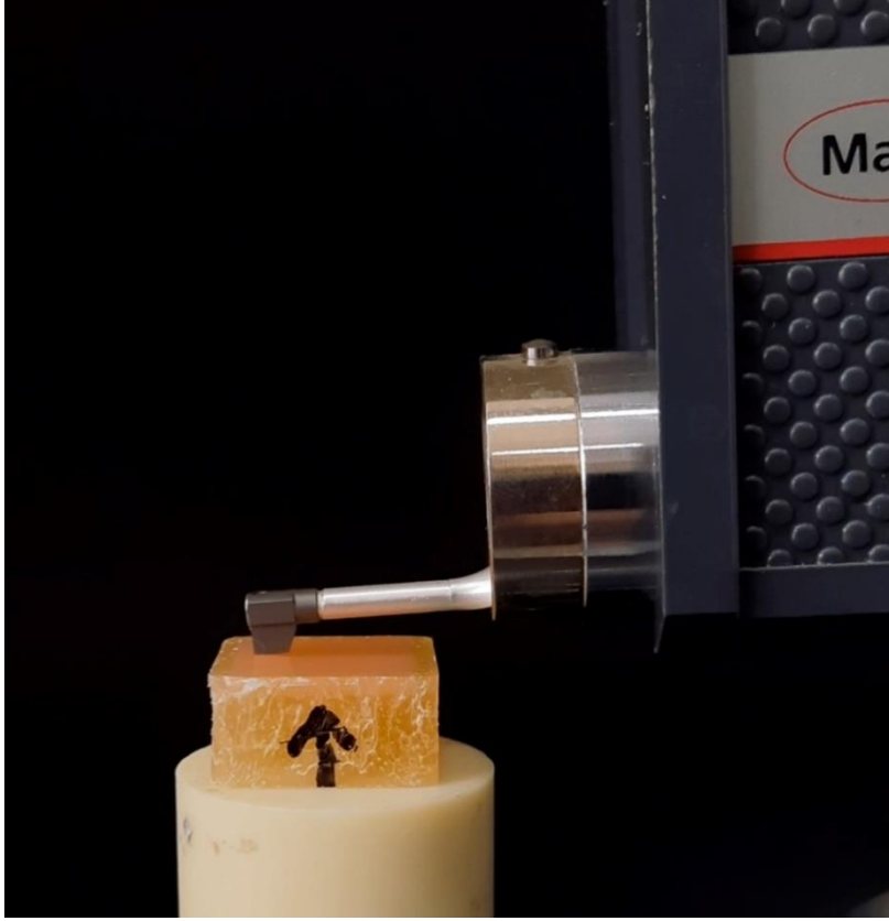
Resim 3.9. CAD/CAM PMMA kaide materyali test örneklerinin yüzey işleme öncesinde yüzey pürüzlülük değerlerinin ölçümü
