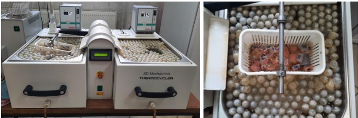
Resim 3.22. Test örneklerinin termal döngü cihazı ile yaşlandırma işlemine tabii tutulması
