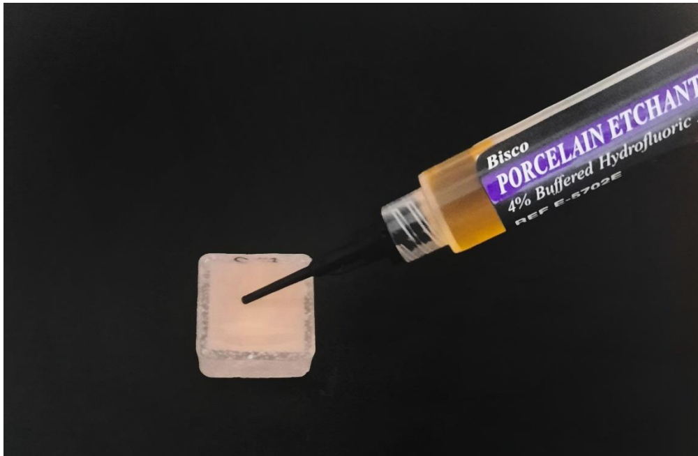
Resim 3.10. CAD/CAM PMMA kaide materyali test örneğinin %4'lük HF asit ile pürüzlendirilmesi
