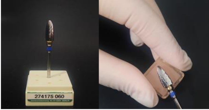
Resim 3.11. Tungsten karbit frez ile CAD/CAM PMMA akrilik kaide materyali test örneği yüzeyi aşındırılması
