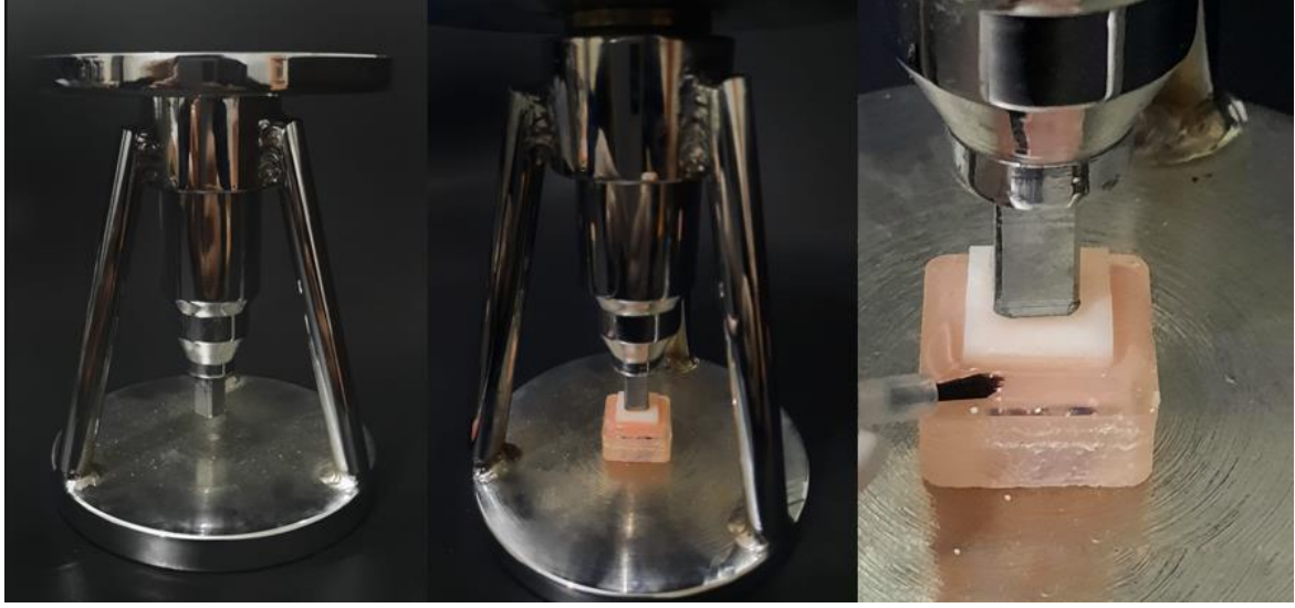
Resim 3.21. Özel yükleme cihazı, PMMA diş materyalinin özel yükleme cihazı ile yapıştırılması, yapıştırma işlemi esnasından taşan yapıştırıcı ajanın temizlenmesi
