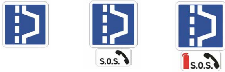
Şekil 3.3. Cepler (yol tünelleri için Viyana anlaşmasının E işaretleri) [14]
