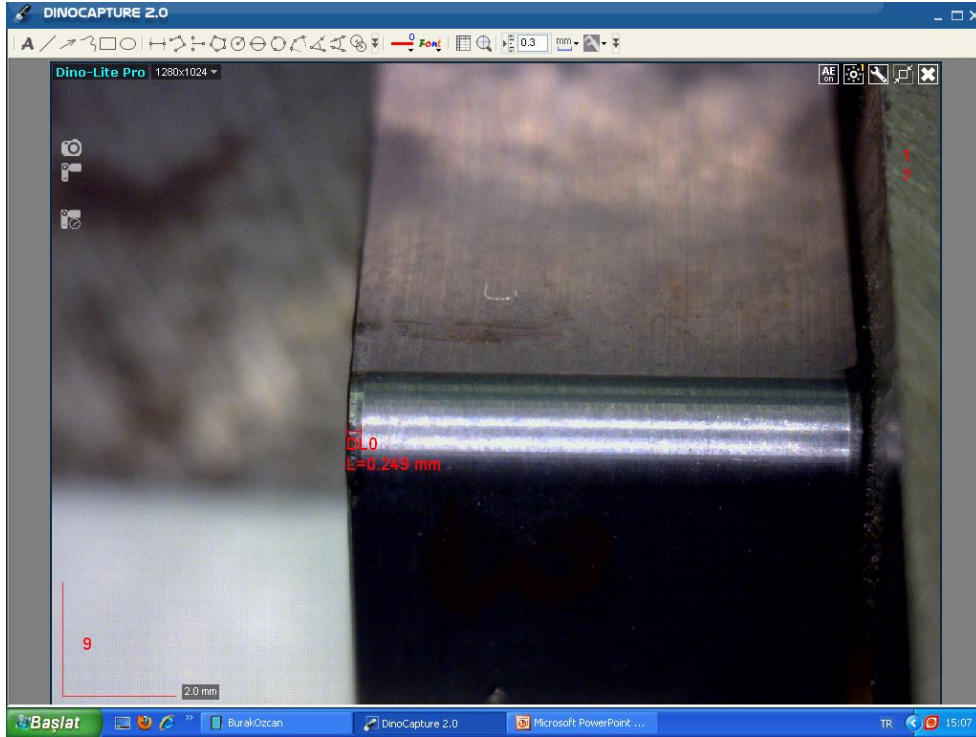
Şekil 5.4. Dino-Lite mikroskobunda kesici takımlarda oluşan aşınmasının ölçülmesi
