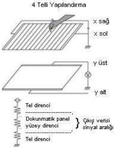
Şekil 4.9 Dört telli dirençsel dokunmatik panel
