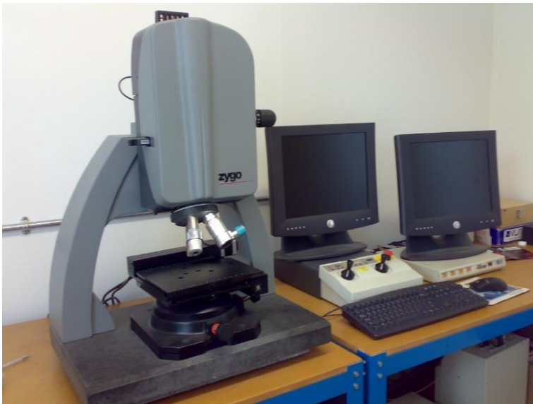
Şekil 3.19.3-D tarama enterforemetre sistemi Bournemouth Üniversitesinde
