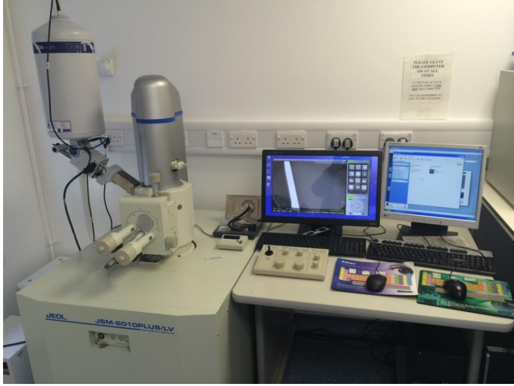
Şekil 3.16. SEM ve EDS sistemi (Bournemouth Üniversitesi)
