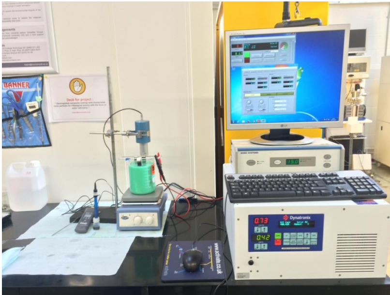
Şekil 3.7. Pulselektrodepozisyon sistemiBournemouth Üniversitesi laboratuvarında
