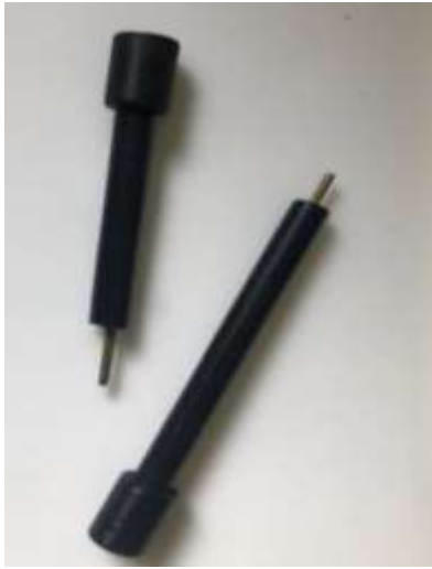
Şekil 3.1. Malzemesi teflon olan ve özel olarak hazırlanan karbon pasta elektrot
