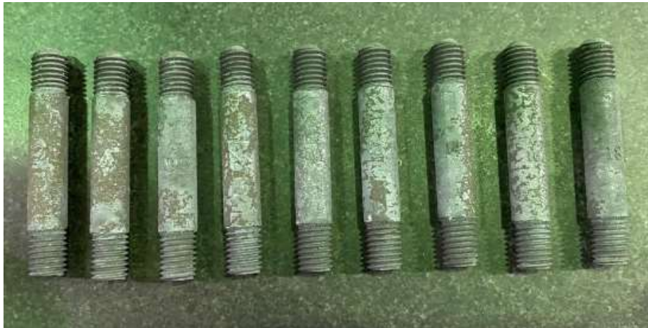
Resim 4.6. Isıtma işlemi uygulanmış silindirik numunelerin yan yana dizili görüntüsü
