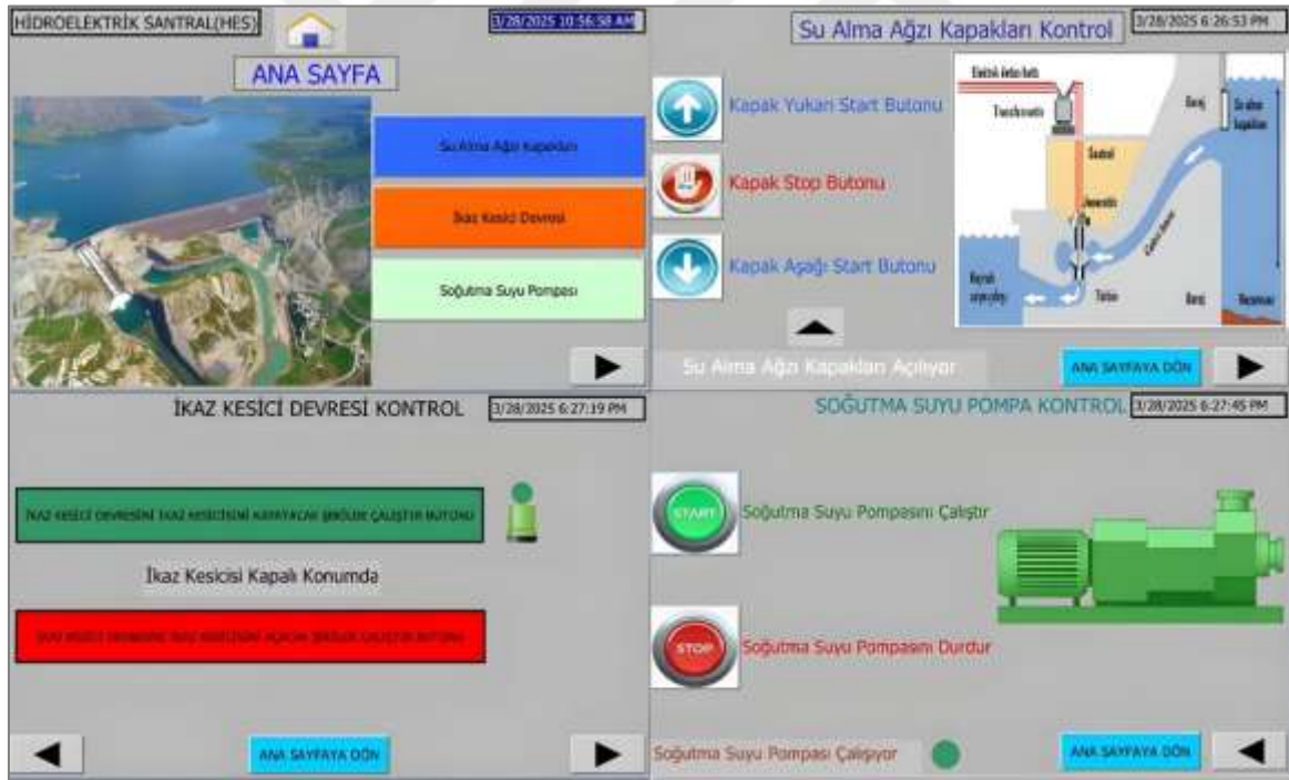
Şekil 4.4. SCADA sistemindeki komutların modellenmesine ilişkin ekran görüntüleri
