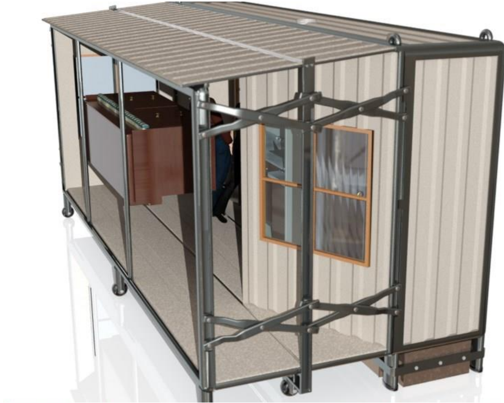
Resim 6.10. Yan duvar panellerinin açılma aşaması 2
