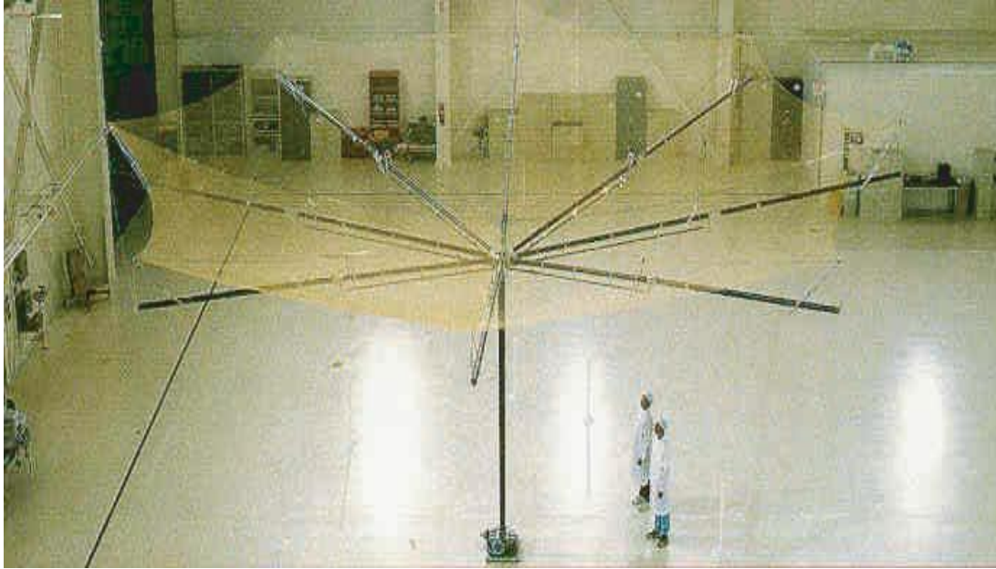
Resim 4.7. ACeS sistemi için 12 m çapında menteşeli kaburga anten [18]
