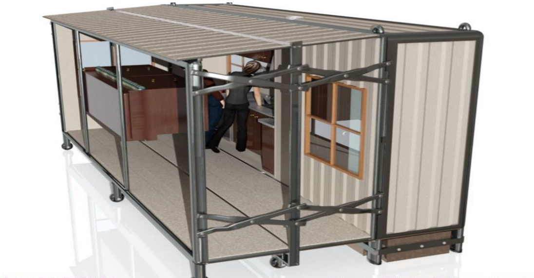
Resim 6.9. Yan duvar panellerinin açılma aşaması 1
