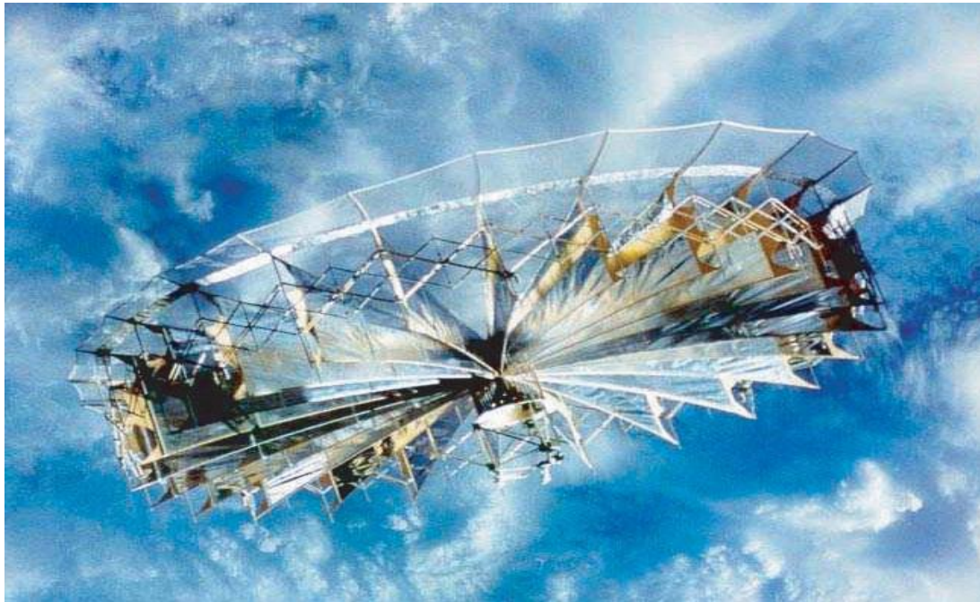
Resim 4.8. A 5,6 çaplı bir EGS antenin uzayda görüntüsü. MIR yörünge istasyonundan 28 Temmuz 1999 tarihinde alınan fotoğraf [Enerji – GPI-Uzay Şirketi' nin izniyle]
