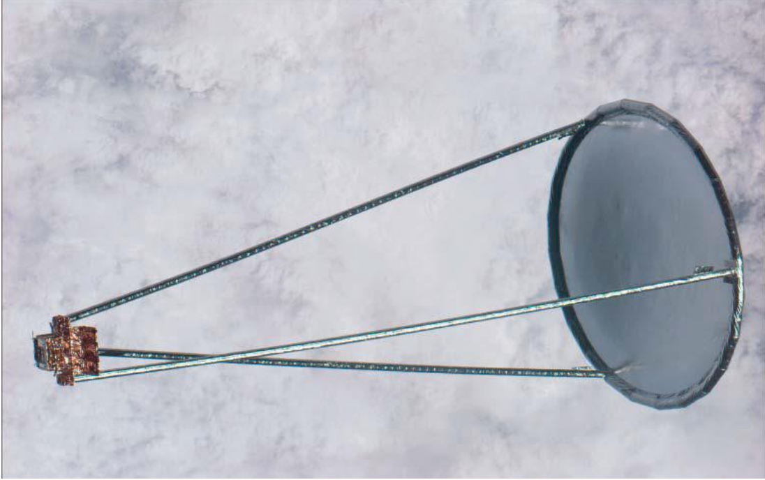
Resim 4.14. 14 m çaplı IAE reflektör antenin uzayda görüntüsü [L' Garde ]
