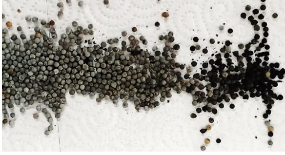
Resim 5.8. Membran tüpün içi ve dışı arasında basınç farkı yaratılmadan yürütülen katalitik test çalışması sonucu K-Cr-S katalizörü ( T=600^{\circ}\text{C} , \text{WHSV}=0,5 \text{ sa}^{-1} )
