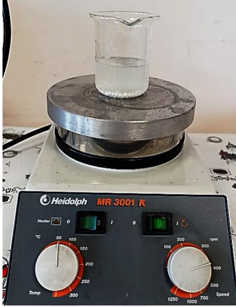
Resim 4.2. K-Cr-S numunesine ait karıştırma düzeneği
