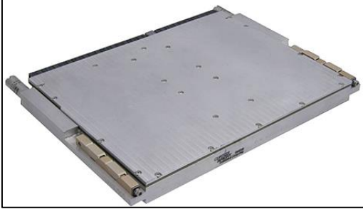
Resim 2.6. Sıvı soğutmalı modül [14]
