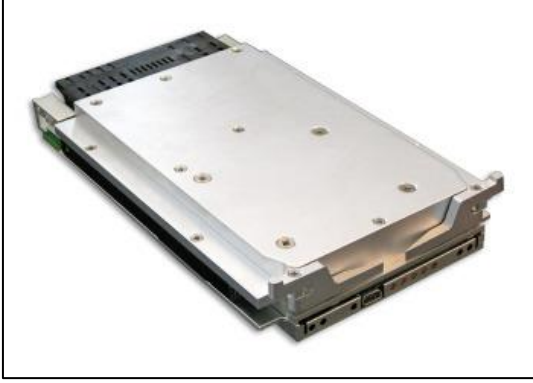
Resim 2.2. İletim ile soğutmalı modül [9]
