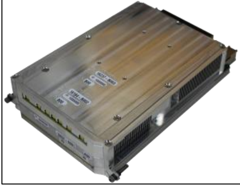
Resim 2.5. Doğrudan hava soğutmalı modül [12]
