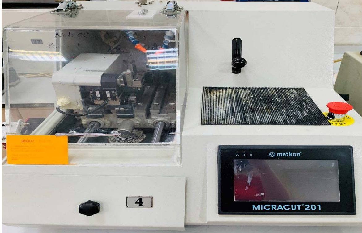
Resim 3.4. Kesit alma cihazı (Metkon Microcut 201, Bursa, Türkiye)
