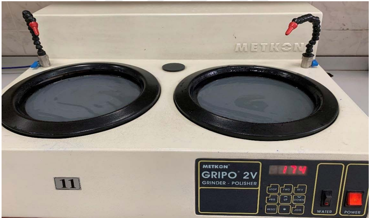
Resim 3.7. Zımparalama ve parlatma cihazı (Metkon Gripo 2V, Bursa, Türkiye)
