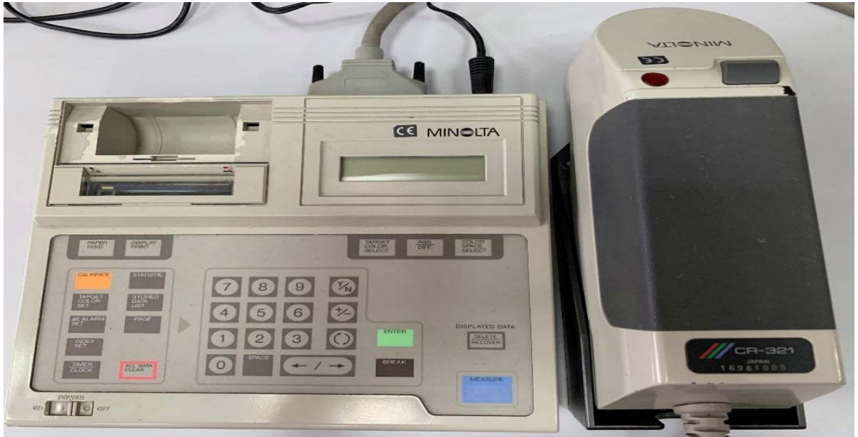
Resim 3.12. Renk lm cihazı (Minolta CR-321, Osaka, Japonya)
