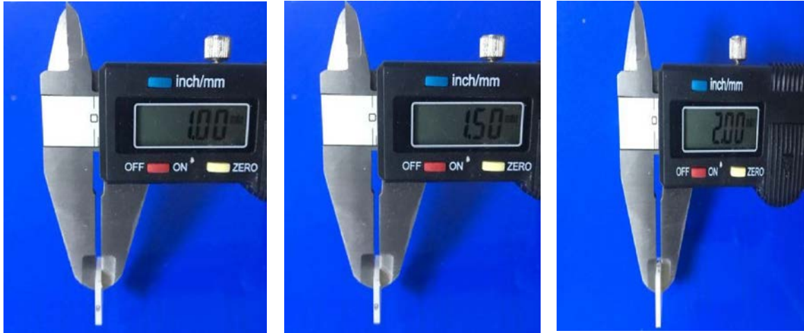
Resim 3.5. Dijital kumpas ile örnek kalınlıklarının ölçülmesi
