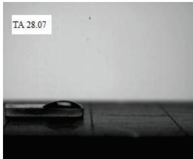
Resim1.6. %6 TEOT /TEOS ile kaplanan cam yüzeyin temas açısı
