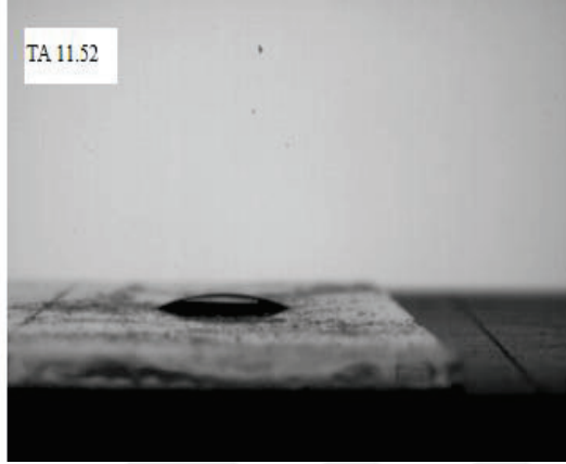
Resim 6.9. %2 TEOT /TEOS ile kaplanan cam yüzeyin temas açısı
