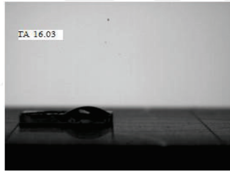
Resim1.2. %4 CeO 2 /TEOS ile kaplanan cam yüzeyin temas açısı
