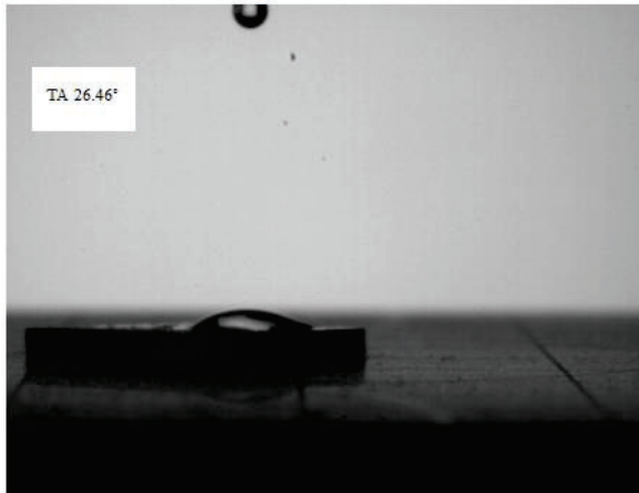
Resim 6.6. %10 \text{Cr}(\text{NO}_3)_3 /TEOS ile kaplanan cam yüzeyin temas açısı
