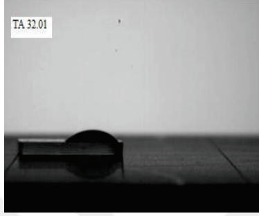
Resim1.7. %10 TEOT /TEOS ile kaplanan cam yüzeyin temas açısı
