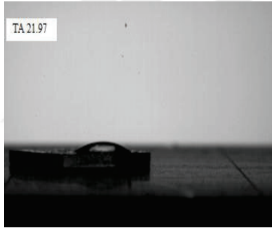
Resim1.5. %4 TEOT /TEOS ile kaplanan cam yüzeyin temas açısı
