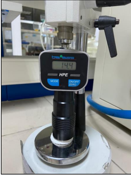
Resim 4.4. Shore-D sertlik analizi cihazı
