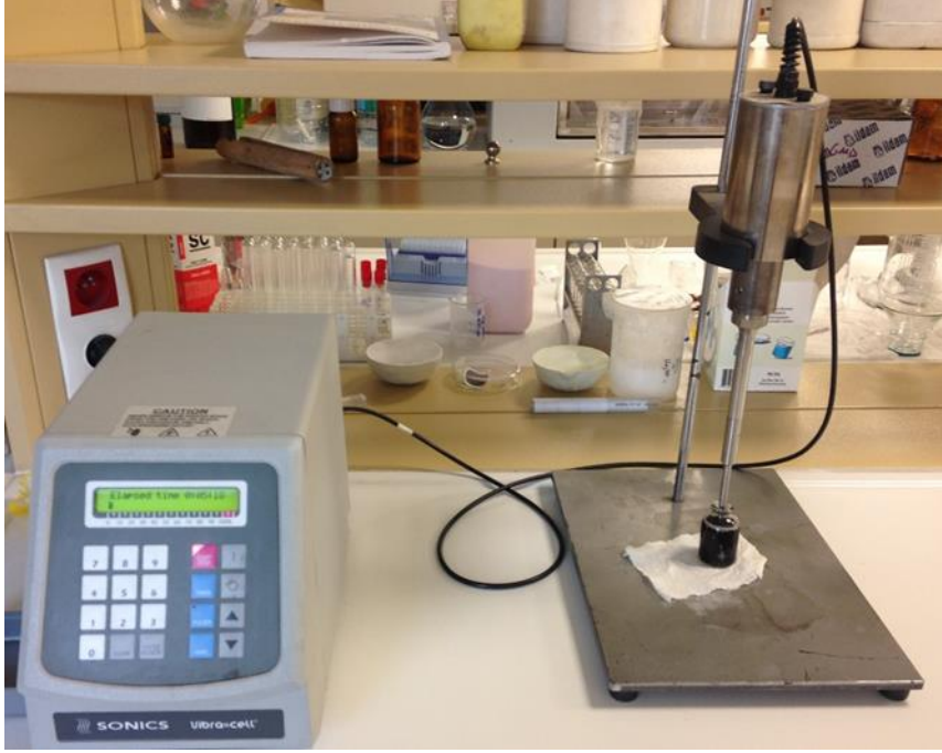
Resim 3.2. Ultrasonik karıştırma cihazı VCX 130 (Sonics®, Switzerland)
