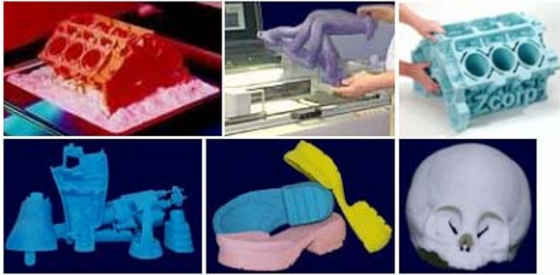
Resim 3.5. Z-Corp. Z310 HPÜ cihazı ile inşa edilen prototip örnekleri [6, 26]
