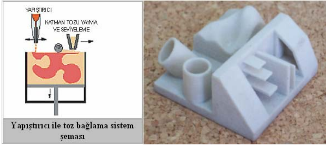
Şekil 3.7. Yapıştırıcı ile toz bağlama HPÜ yönteminin çalışma prensibi ve bu yöntem ile inşa edilen model
