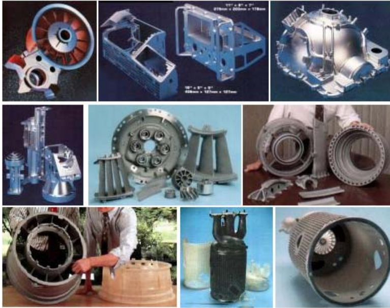
Resim 4.2. Askeri elektronik cihazların kasaları ve jet türbin parçalarından örnekler [6, 26]
