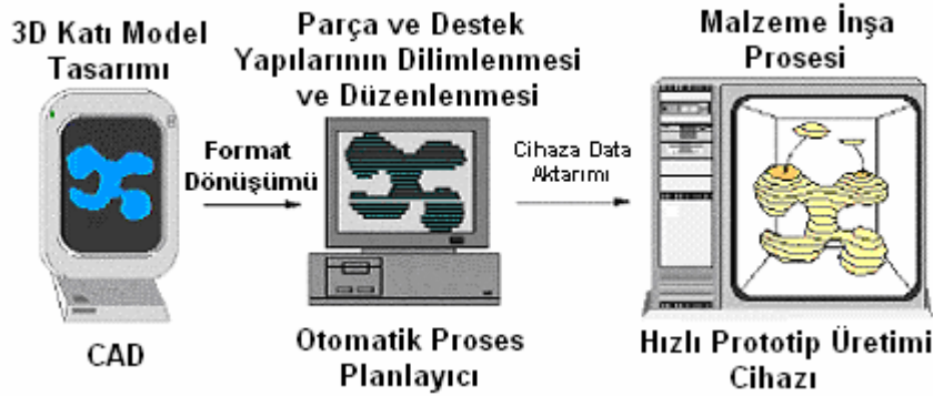
Şekil 3.1. HPÜ sisteminde genel aşamalar [6, 26]
