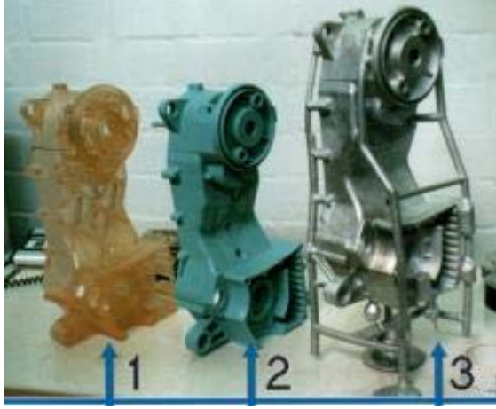
Resim 4.5. MCP Metal Part Casting sistemine örnek bir çalışma [6, 26]
