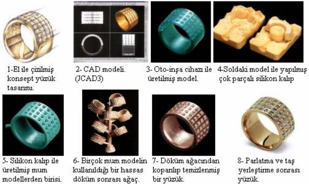
Şekil 3.19. Mücevher tasarım ve imalat uygulamasının aşamaları [6, 26]
