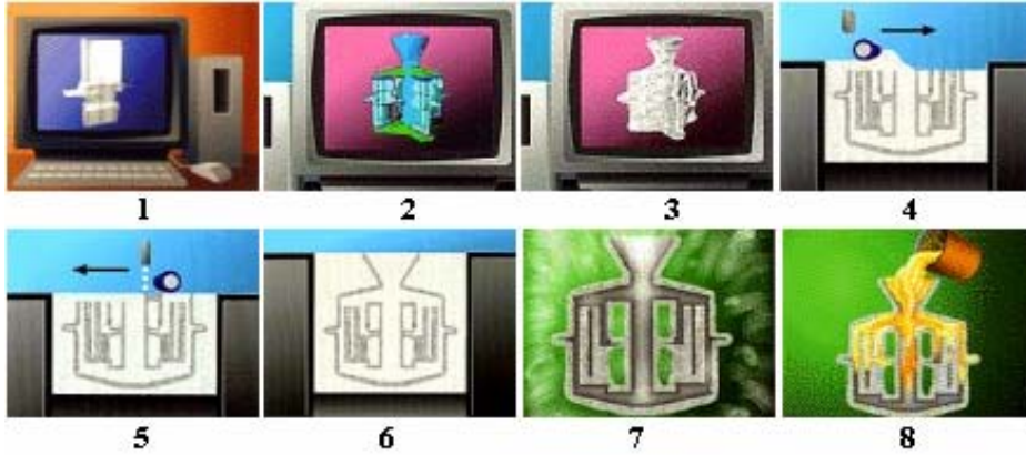
Şekil 4.2. Doğrudan kabuk imalatıyla döküm tekniğinin safhaları [6, 26]
