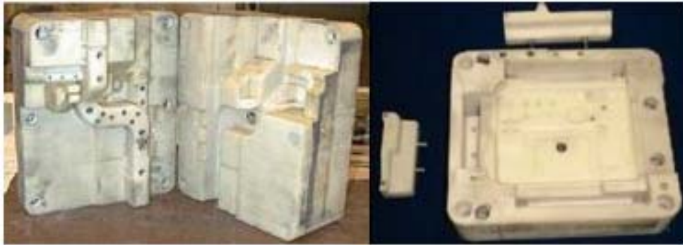
Resim 3.19. Takviyeli fotopolimer reçinesiyle imal edilmiş kalıplar [6, 26]
