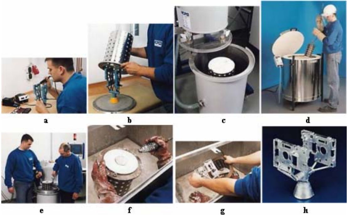
Resim 4.4. MCP Metal Part Casting sisteminin uygulama safhaları [6, 26]
