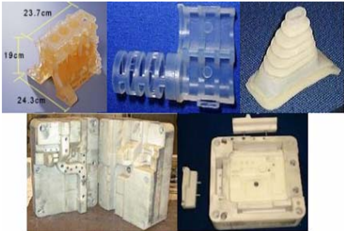
Resim 3.11. SLA HPÜ tekniği ile üretilmiş örnek parçalar [6, 26]
