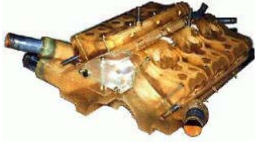
Resim 3.14. Porsche firması tarafından geliştirilen bir motora ait HPÜ prototipi [6, 26]
