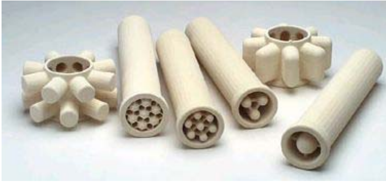
Resim 3.26. Yüksek performanslı seramik filtreler [6, 26]
