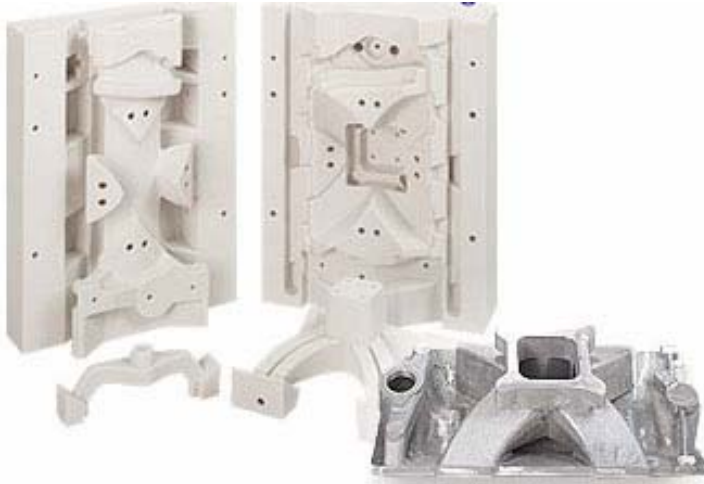
Resim 3.15. Z Cast prosesi ile elde edilmiş döküm kalıbı [6, 26]
