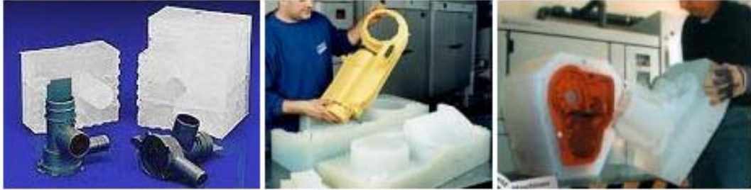
Resim 4.7. Silikon kalıp kullanımına dair örnekler [6, 26]
