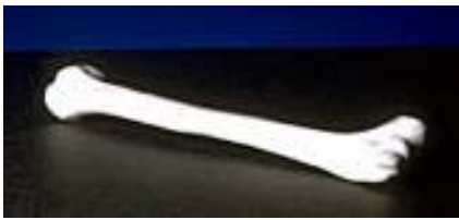
Resim 3.34. HPÜ teknolojisi ile kağıt ve yapıştırıcıdan imal edilmiş bir insan kemiği modeli [6, 26]
