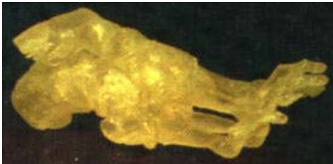
Resim 3.35. Özürlü bir Ayağın SLA ile inşa edilmiş modeli [6, 26]
