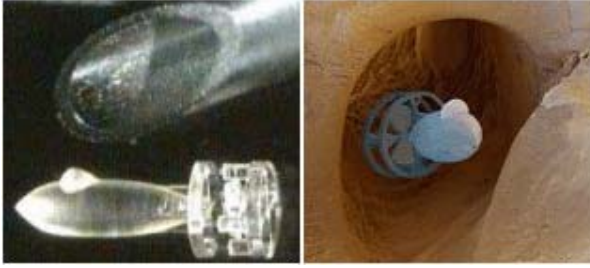
Resim 3.28. Bir enjektör iğnesinin içine girebilecek kadar küçük motor , mekanizmalar ve denizaltı [6, 26]
