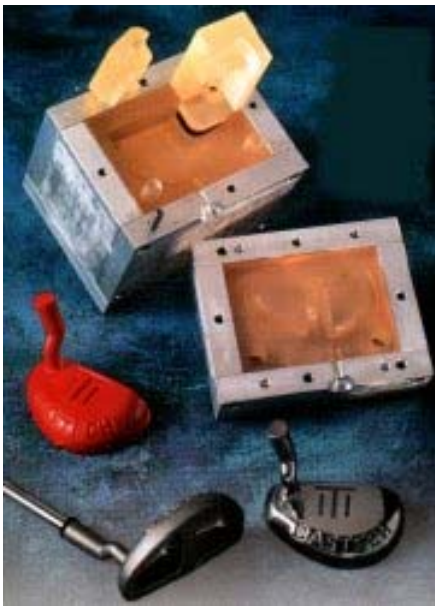
Resim 3.21. SLA tekniği ile inşa edilmiş mum basma kalıbı [6, 26]
