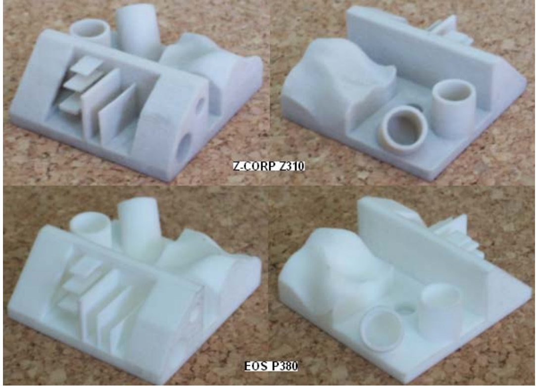
Resim 6.2. Z-Corp Z310 ve EOS P380 HPÜ cihazlarında üretilen modeller ve unsurları
