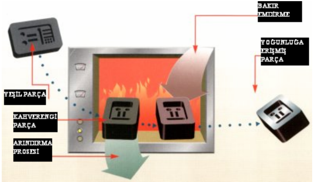
Şekil 3.14. Rapid Tool tekniği safhaları [6, 26]
