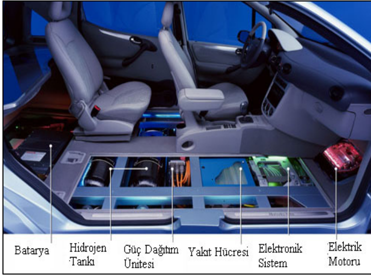
Şekil 2.11. Bir araç üzerinde yakıt pili sistemi gösterimi [32]
