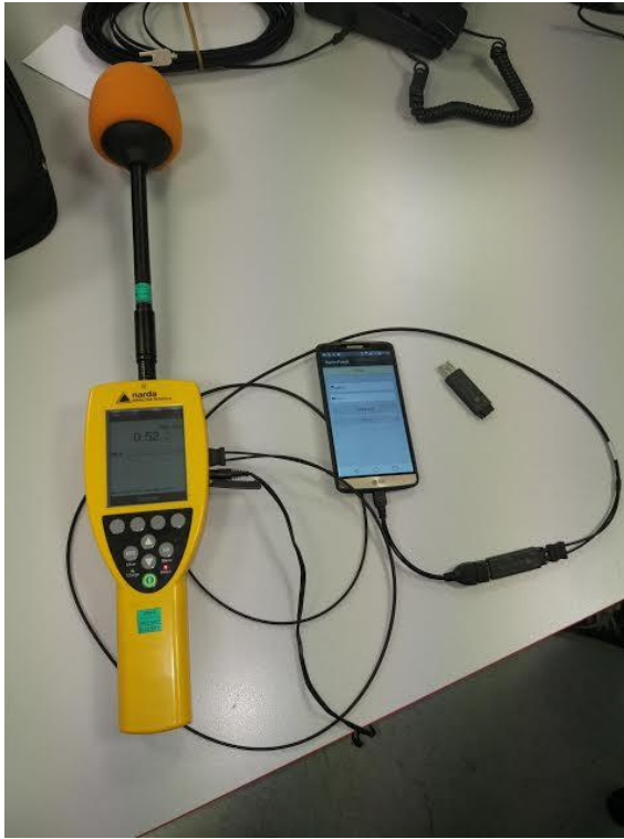
Şekil 4.7. NBM-550 ölçüm cihazının Android telefona bağlanması ve sistemin çalışması
