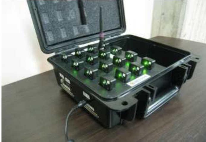
Resim 3.5. Delsys Trigno™ yüzeysel EMG cihazı
