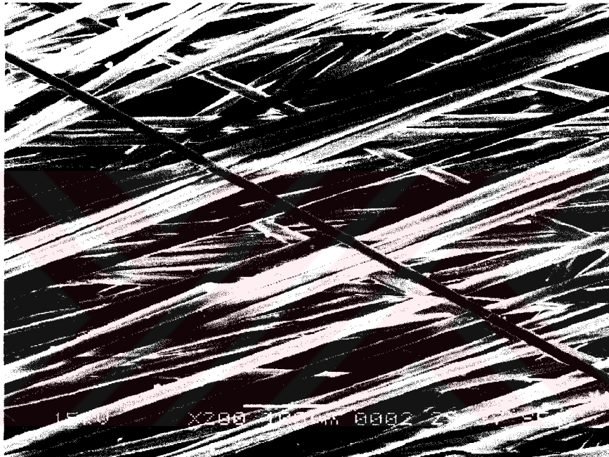
Resim 4.2. \text{SiO}_2 fiber SEM görüntüsü
